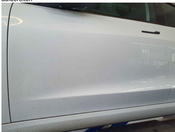
Beschädigung #1: Karosserie: Karosserie (Flugrost) - verschmutzt - aufbereiten
