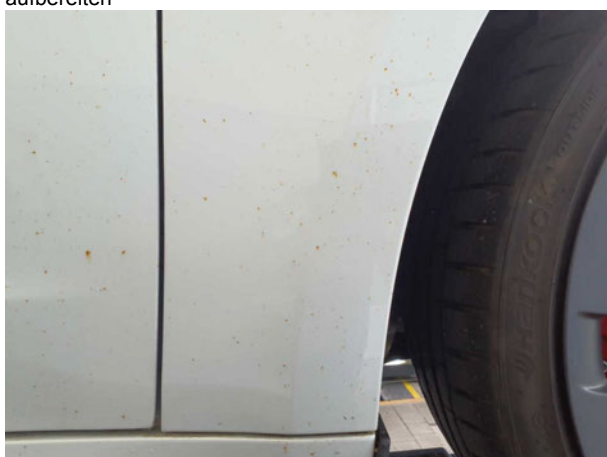
Beschädigung #1: Karosserie: Karosserie (Flugrost) - verschmutzt - aufbereiten
