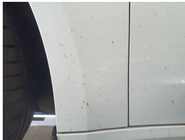
Beschädigung #1: Karosserie: Karosserie (Flugrost) - verschmutzt - aufbereiten
