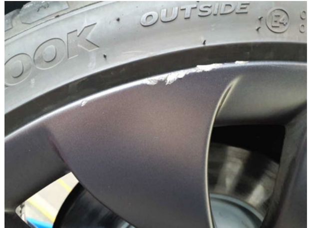
Beschädigung #3: Rad/Reifen: Leichtmetallfelge vorn links - verkratzt / verschürft - erneuern
