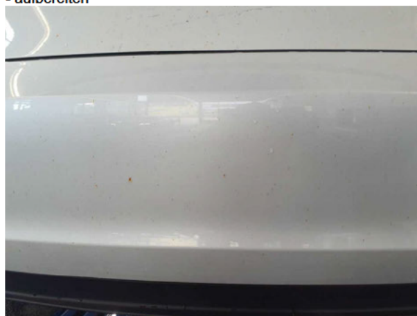
Beschädigung #1: Karosserie: Karosserie (Flugrost) - verschmutzt - aufbereiten
