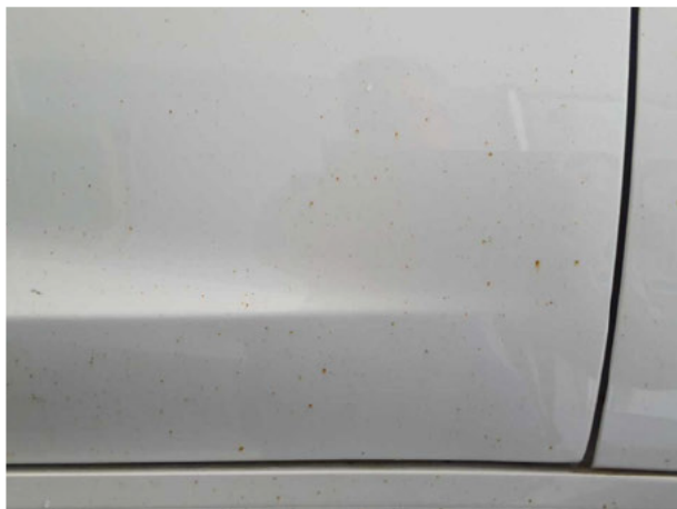
Beschädigung #1: Karosserie: Karosserie (Flugrost) - verschmutzt - aufbereiten
