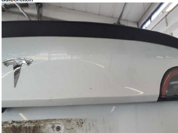
Beschädigung #1: Karosserie: Karosserie (Flugrost) - verschmutzt - aufbereiten
