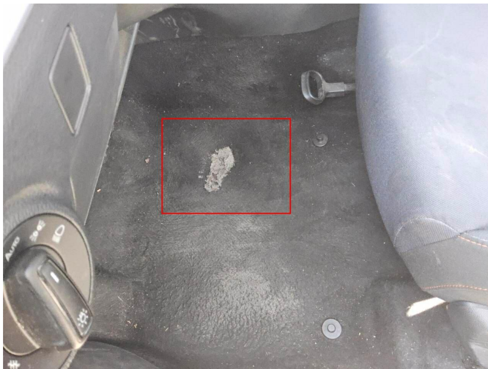
Bild 32 : Bodenbelag vorne, gerissen
