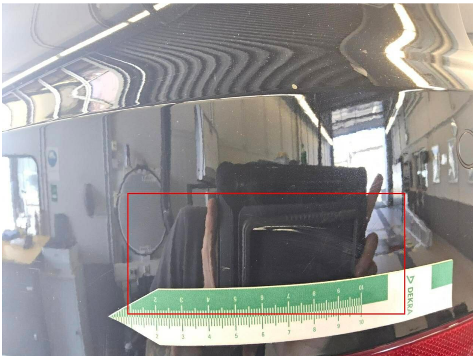
Bild 16 : Stoßfänger hinten, zerkratzt, lackieren
