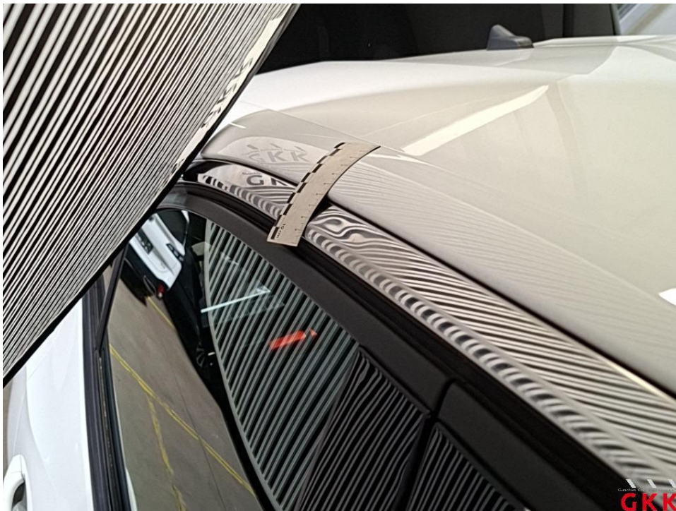
Bild 26 Seitenwand rechts, Blende -Fensterrahmen-, beschädigt, ersetzen
