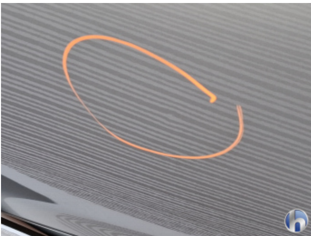
6. Tür Vorne - Links 1 Delle - Sanft Instandsetzen
