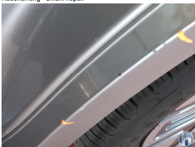
4. Seitenwand - Hinten - Links Abschürfung - Smart Repair
