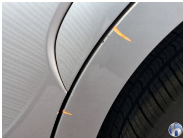
4. Seitenwand - Hinten - Links Abschürfung - Smart Repair
