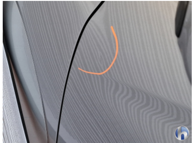
6. Tür Vorne - Links 1 Delle - Sanft Instandsetzen
