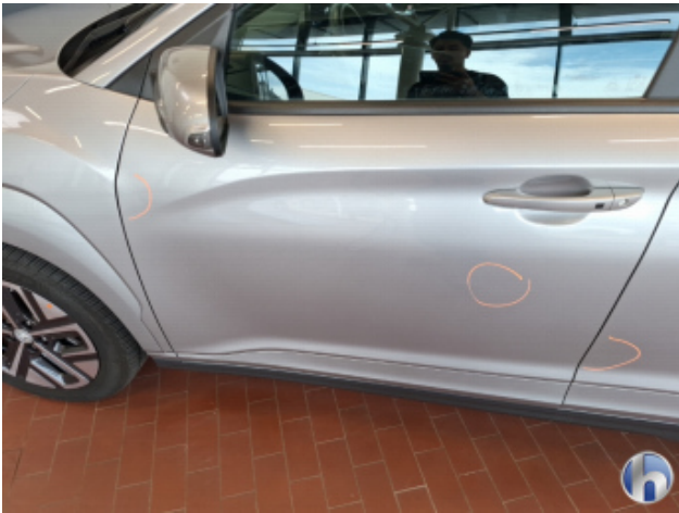
6. Tür Vorne - Links 1 Delle - Sanft Instandsetzen
