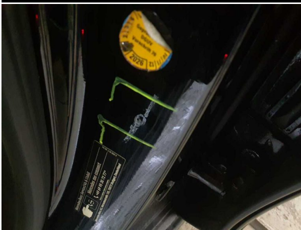
Beschädigung #3: Schweller links: Einstieg - Delle / Lackschade... Smart Repair
