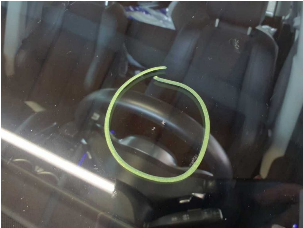
Beschädigung #6: Verglasung: Frontscheibe (Mit Rissbildung) - Steinschlag - erneuern
