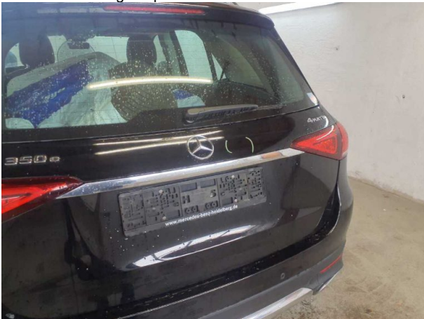
Beschädigung #2: Heckklappe/-tür: Heckklappe - Delle(n) - sanft instandsetzen
