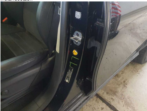
Beschädigung #3: Schweller links: Einstieg - Delle / Lackschade... Smart Repair
