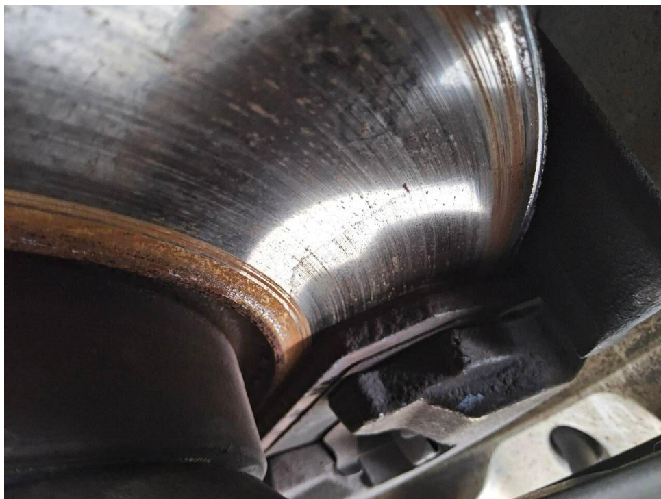
Bild 25 : Bremsscheiben Vorderachse Tragbild mangelhaft, Riefen-und Korrosionsbildung Bremsbelag in Kürze verschlissen
