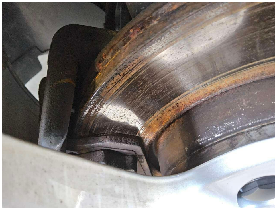
Bild 24 : Bremsscheiben Vorderachse Tragbild mangelhaft, Riefen-und Korrosionsbildung Bremsbelag in Kürze verschlissen
