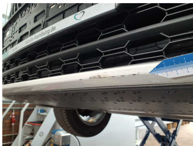
Damage 4: Front bumper: Front bumper (Mit Klebe Rückstände) - Scratch(es) - Smart repair
