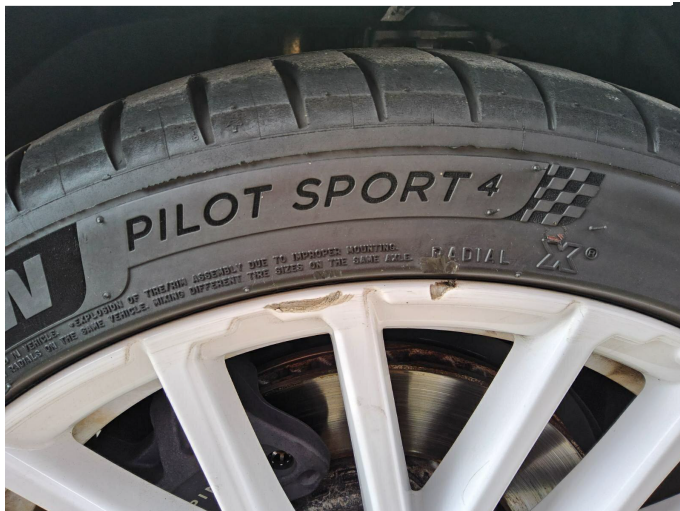
Bild 1: Außen, Felge hinten rechts, zerkratzt, lackieren Reifen hinten rechts beschädigt
