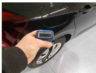
Lackstärke Seitenwand hinten rechts
