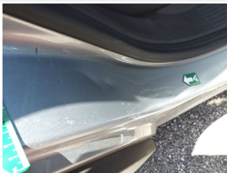
Entrée de porte / Arrière Droit / Enfoncement
