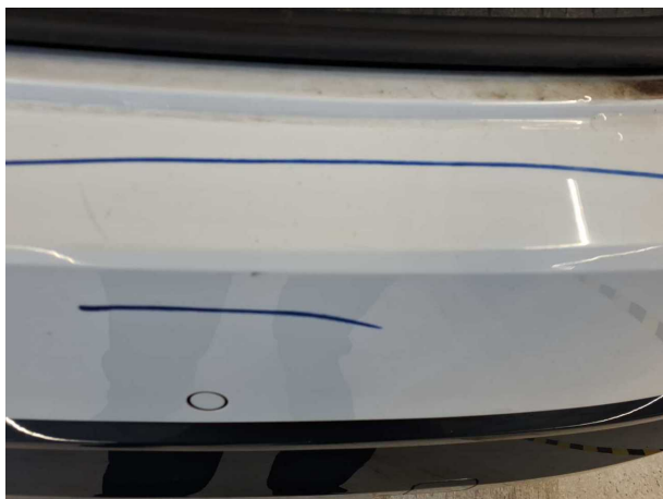
Beschädigung #10: Stossfänger hinten: Stossfänger hinten - Kratzer - lackieren
