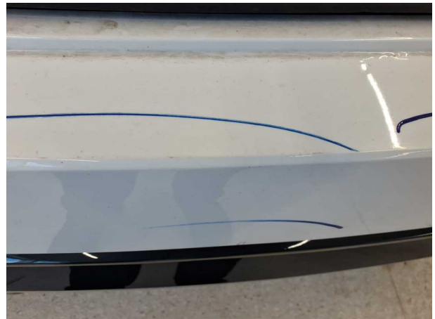
Beschädigung #10: Stossfänger hinten: Stossfänger hinten - Kratzer - lackieren
