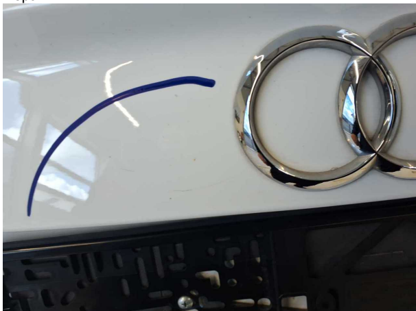
Beschädigung #7: Heckklappe/-tür: Heckklappe - Kratzer - Smart Repair
