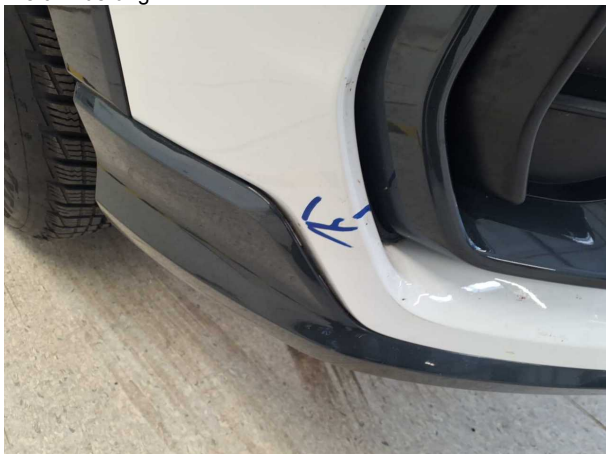
Beschädigung #5: Stossfänger vorn: Spoiler - nicht fachgerecht instandgesetzt - instandsetzen
