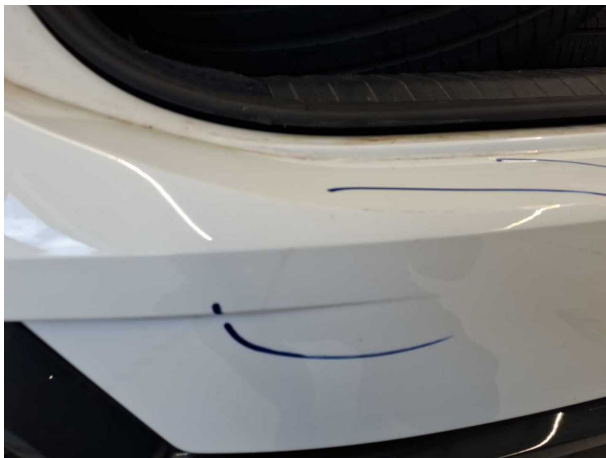
Beschädigung #10: Stossfänger hinten: Stossfänger hinten - Kratzer - lackieren
