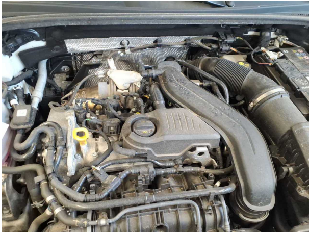
Beschädigung #6: Motor: Motorabdeckung - Marderschaden - erneuern
