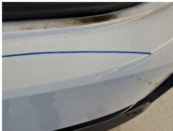
Beschädigung #10: Stossfänger hinten: Stossfänger hinten - Kratzer - lackieren
