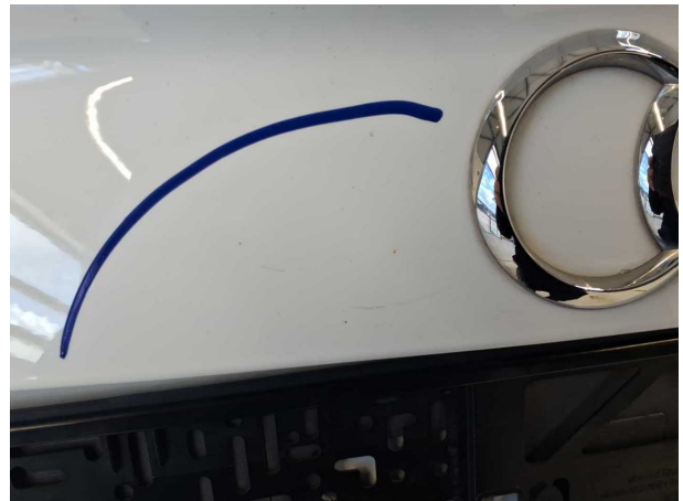
Beschädigung #7: Heckklappe/-tür: Heckklappe - Kratzer - Smart Repair
