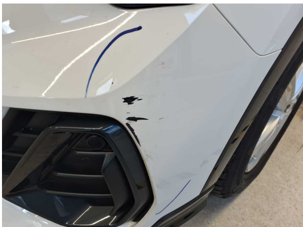
Beschädigung #9: Stossfänger vorn: Stossfänger vorn - Kratzer - lackieren
