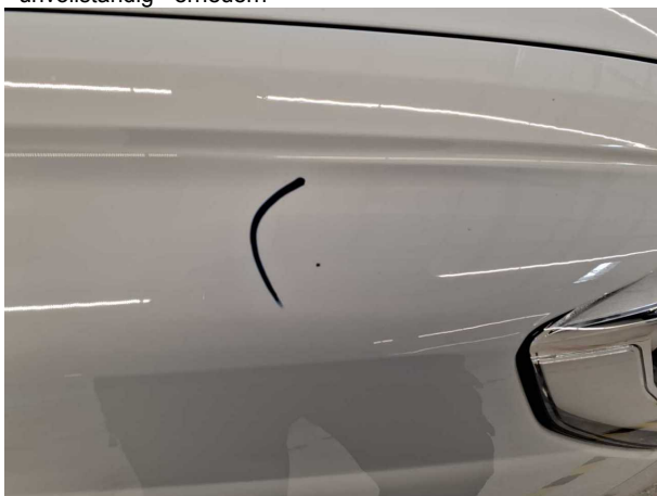
Beschädigung #2: Kotflügel rechts: Kotflügel rechts - Steinschlag - auslegen / polieren
