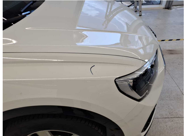
Beschädigung #2: Kotflügel rechts: Kotflügel rechts - Steinschla... auslegen / polieren
