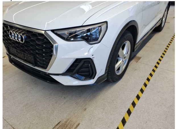
Beschädigung #9: Stossfänger vorn: Stossfänger vorn - Kratzer - lackieren
