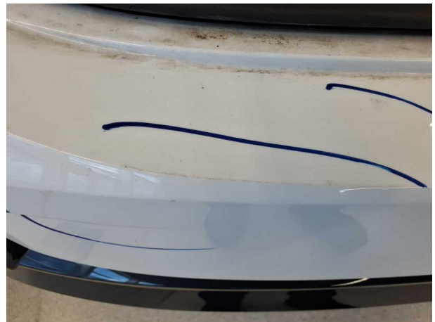
Beschädigung #10: Stossfänger hinten: Stossfänger hinten - Kratzer - lackieren
