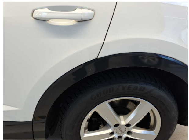
Beschädigung #8: Seitenwand links: Radlauf - Kratzer - Smart Repair
