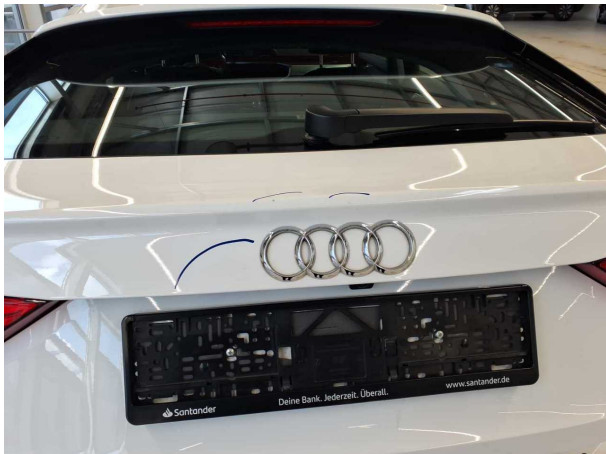
Beschädigung #7: Heckklappe/-tür: Heckklappe - Kratzer - Smart Repair
