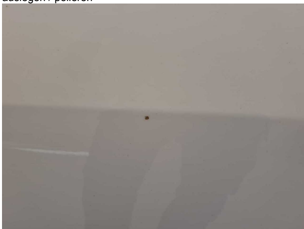
Beschädigung #3: Tür hinten links: Tür - Steinschlag - auslegen / polieren
