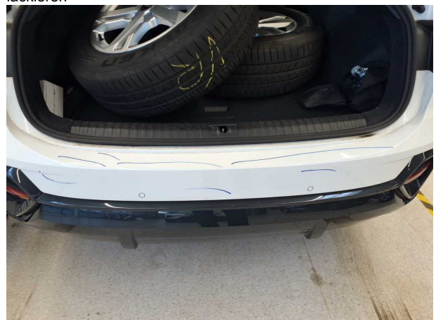
Beschädigung #10: Stossfänger hinten: Stossfänger hinten - Kratzer - lackieren
