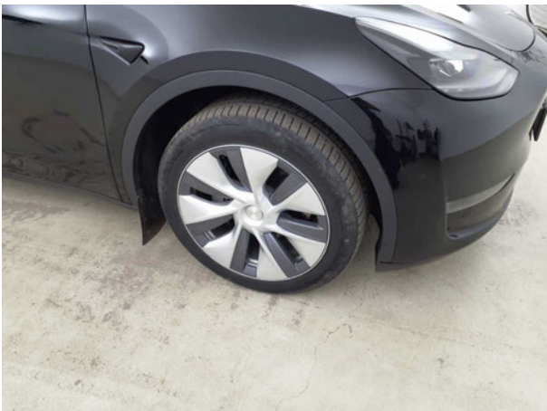
Beschädigung #10: Rad/Reifen: Leichtmetallfelge vorn rechts - verkratzt / verschürft - erneuern
