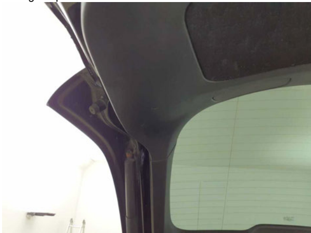
Beschädigung #2: Verkleidungen/Abdeckungen: Heckdeckel, Innenverkleidung - Kratzer - Wertminderung
