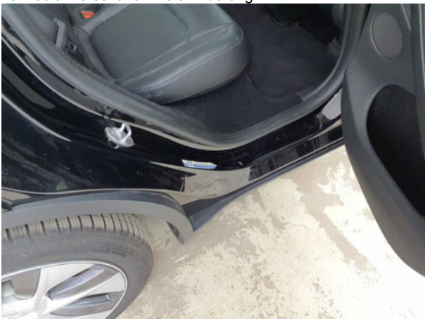
Beschädigung #6: Seitenwand rechts: Einstieg - Kratzer - Smart Repair
