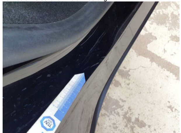
Beschädigung #6: Seitenwand rechts: Einstieg - Kratzer - Smart Repair
