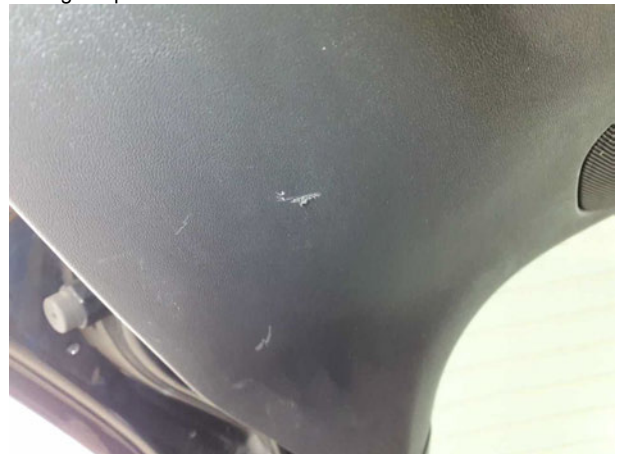
Beschädigung #2: Verkleidungen/Abdeckungen: Heckdeckel, Innenverkleidung - Kratzer - Wertminderung
