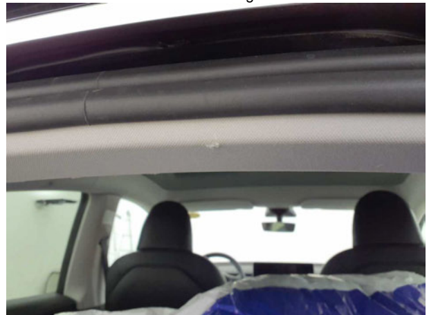
Beschädigung #5: Verkleidungen/Abdeckungen: Dachhimmel - verkratzt / verschürft - Wertminderung
