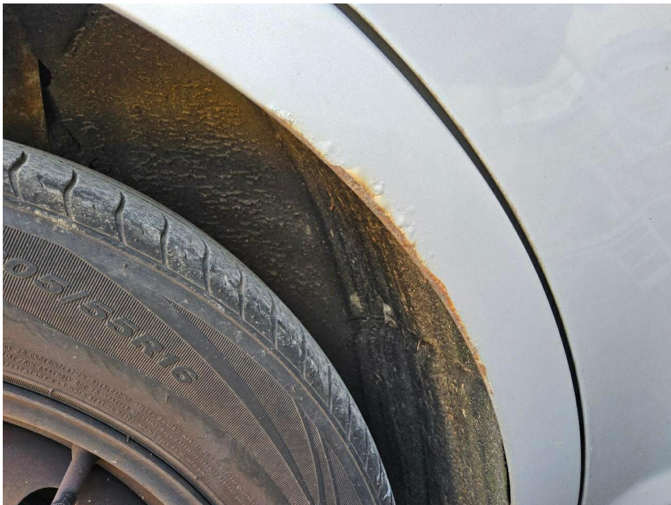
Bild 22 : Seitenwand hinten rechts Rostansatz
