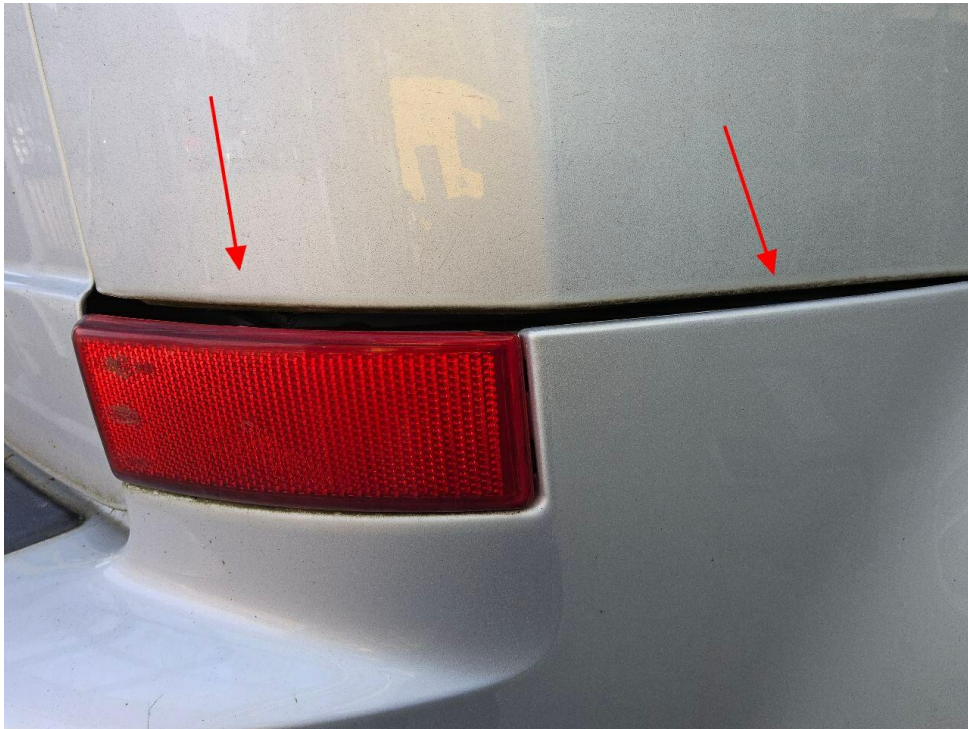
Bild 23 : Stoßfänger hinten Spaltmaß nicht passig
