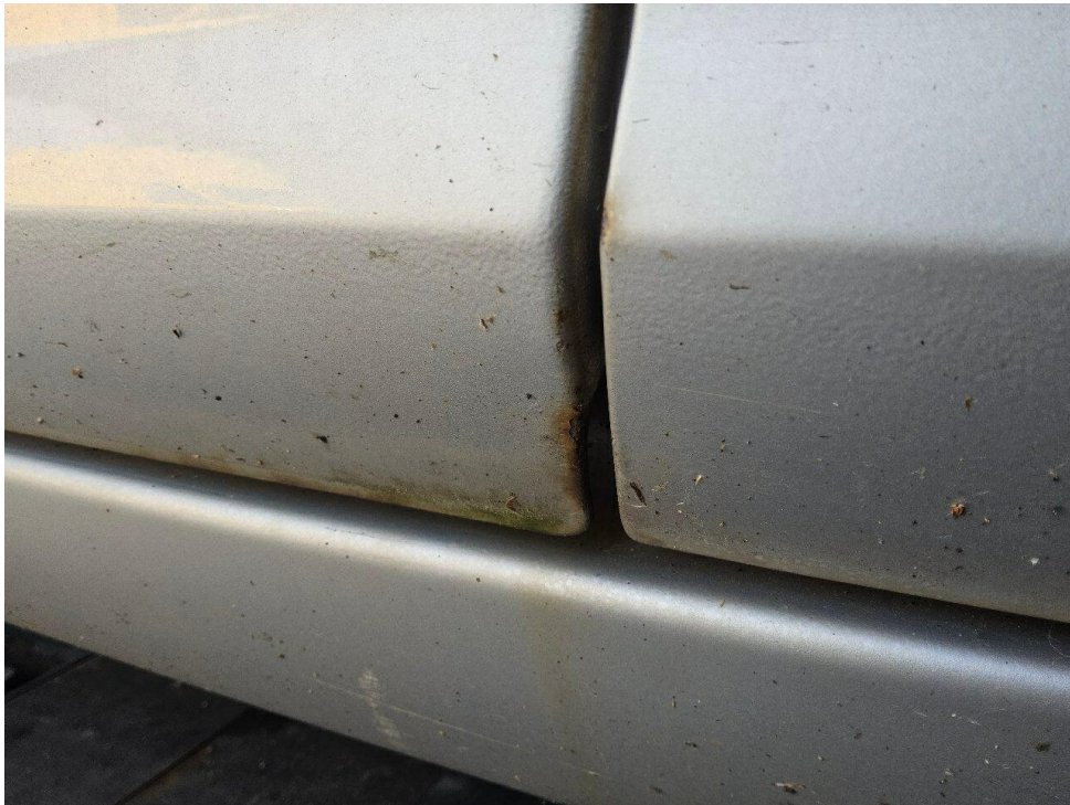
Bild 21 : Tür hinten rechts Rostansatz
