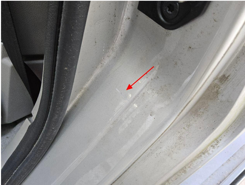
Bild 11 : Tür hinten links Einstieg verschrammt
