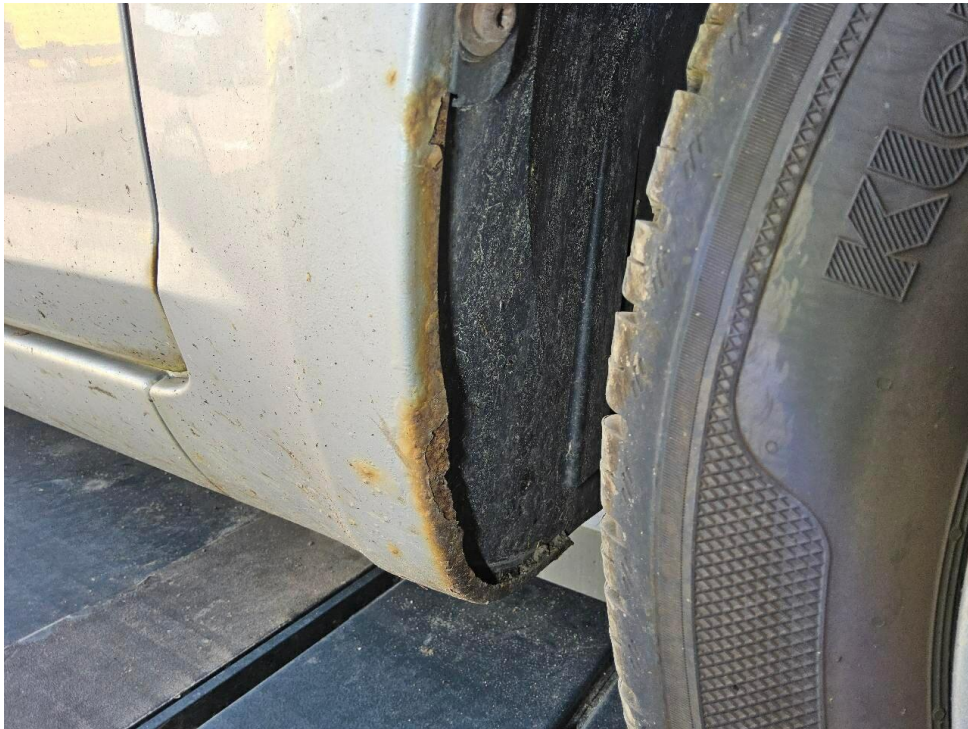
Bild 19 : Kotflügel vorne rechts Rostansatz
