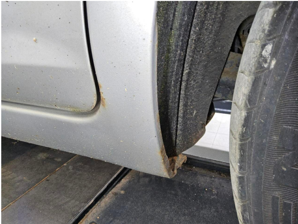
Bild 25 : Seitenwand hinten links Rostansatz
