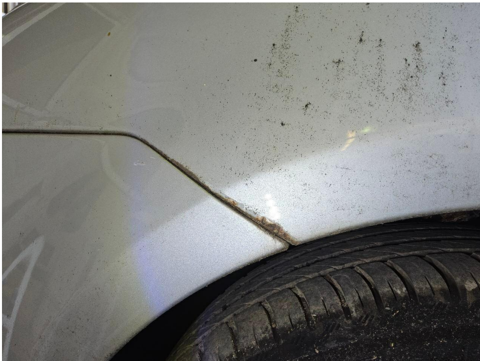
Bild 26 : Kotflügel vorne links Rostansatz
