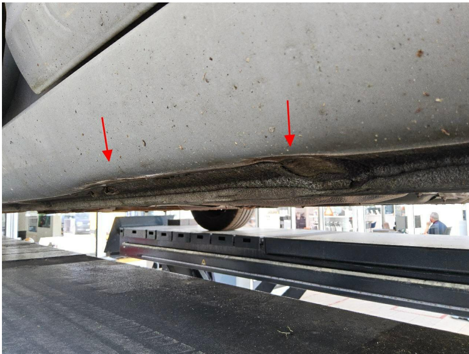
Bild 32 : Schweller links deformiert
