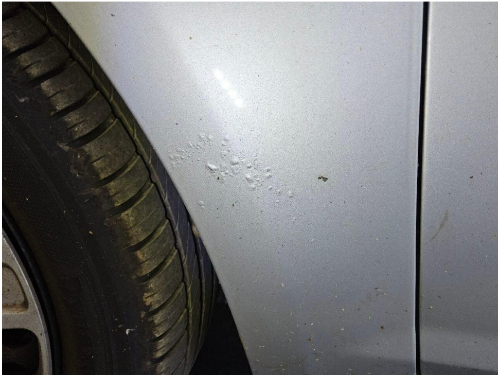
Bild 27 : Kotflügel vorne links Rostansatz
