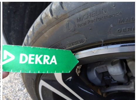
Llanta / Trasero Derecho / Ralladura
