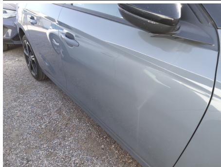
Puerta / Delantero Derecho / Ralladura
