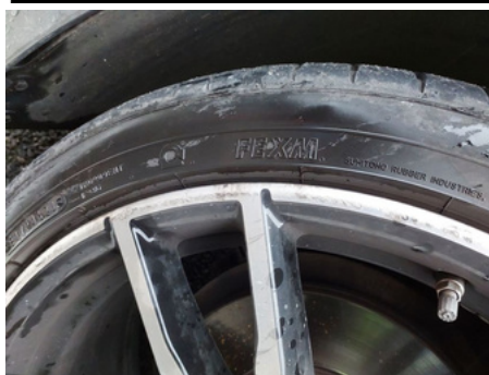
Pneu / Avant Gauche / Non Conforme
