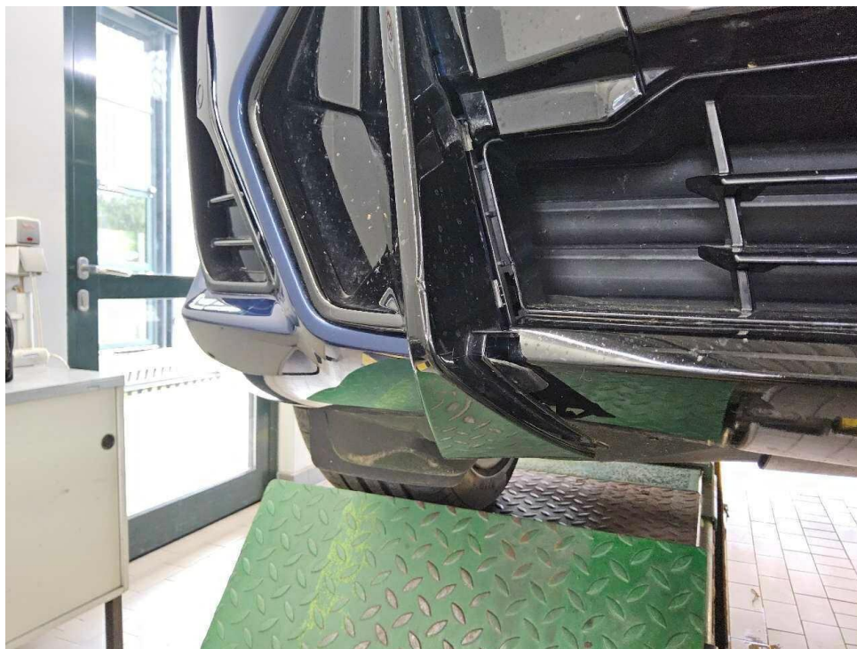
Bild 18 : Stoßfänger vorne, Lackierung zerkratzt und Zierleiste mit Frontspoiler beschädigt
