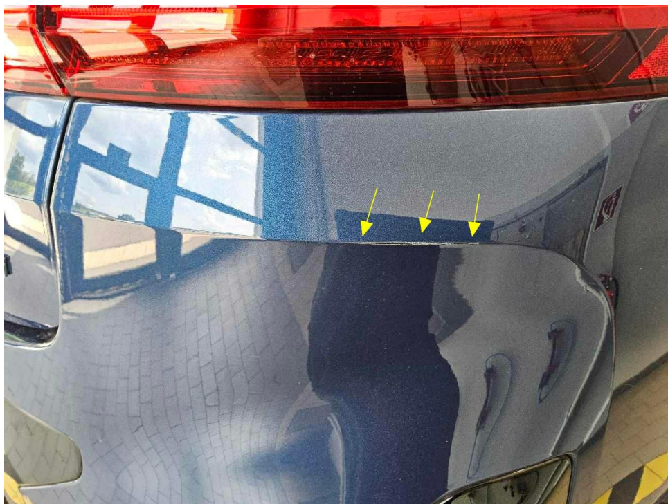
Bild 23 : Stoßfänger hinten, Lackierung zerkratzt
