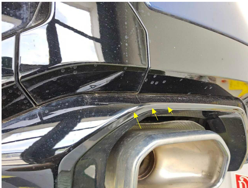
Bild 24 : Stoßfänger hinten, Lackierung zerkratzt
