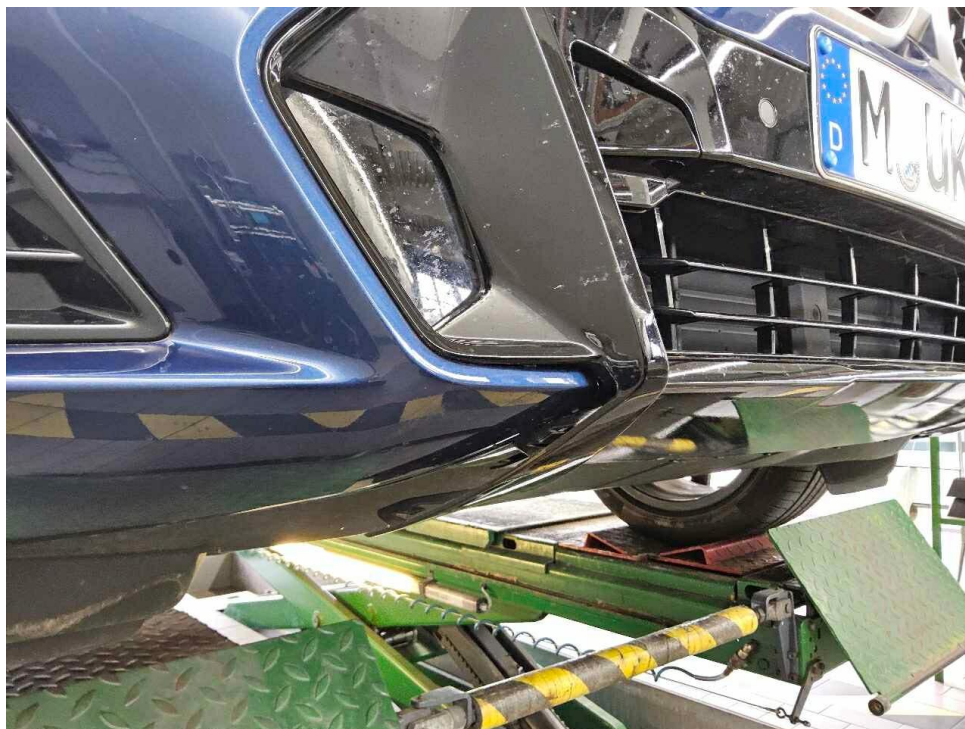
Bild 17 : Stoßfänger vorne, Lackierung zerkratzt und Zierleiste mit Frontspoiler beschädigt
