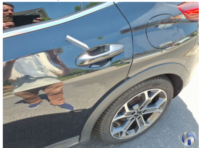
2. Tür Hinten - Links Oberflächenkratzer - Aufbereiten / Polieren
