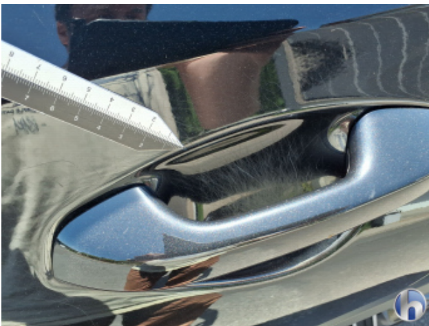
2. Tür Hinten - Links Oberflächenkratzer - Aufbereiten / Polieren
