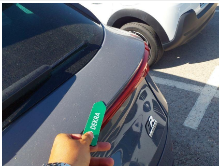
Portón trasero / puerta del maletero / - / Abolladura
