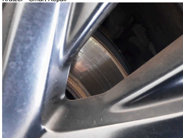
Beschädigung #4: Bremsanlage: Bremsscheiben vorn - verschlissen - erneuern
