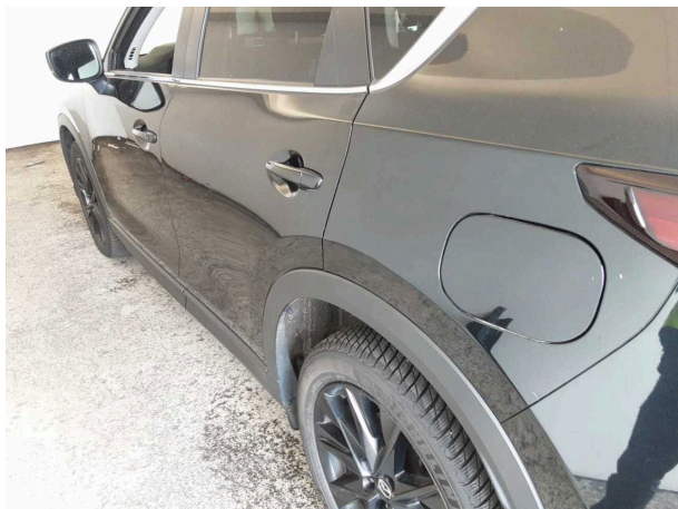
Beschädigung #1: Seitenwand links: Seitenwand - verkratzt / verschürft - Smart Repair
