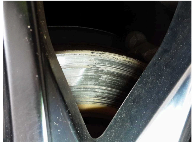
Beschädigung #4: Bremsanlage: Bremsscheiben vorn - verschlissen - erneuern
