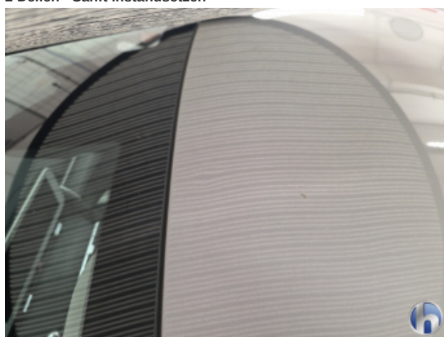
2. Dach Hagelschaden - Sanft Instandsetzen
