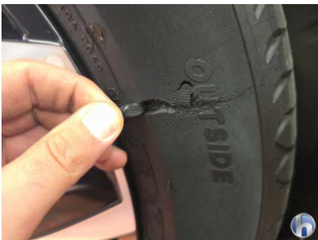
3. Reifen Hinten - Rechts Nicht Verkehrssicher - Erneuern
