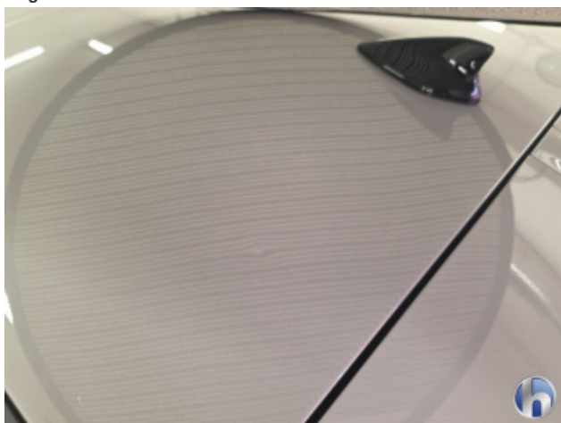
2. Dach Hagelschaden - Sanft Instandsetzen
