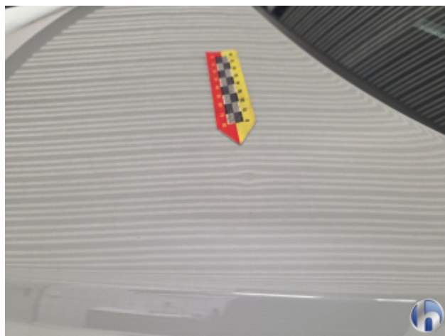
1. Motorhaube 2 Dellen - Sanft Instandsetzen
