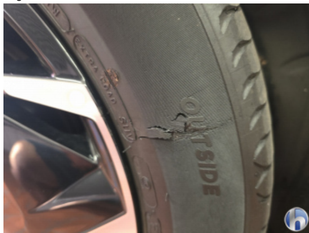
3. Reifen Hinten - Rechts Nicht Verkehrssicher - Erneuern
