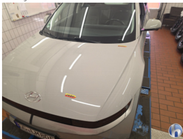
1. Motorhaube 2 Dellen - Sanft Instandsetzen
