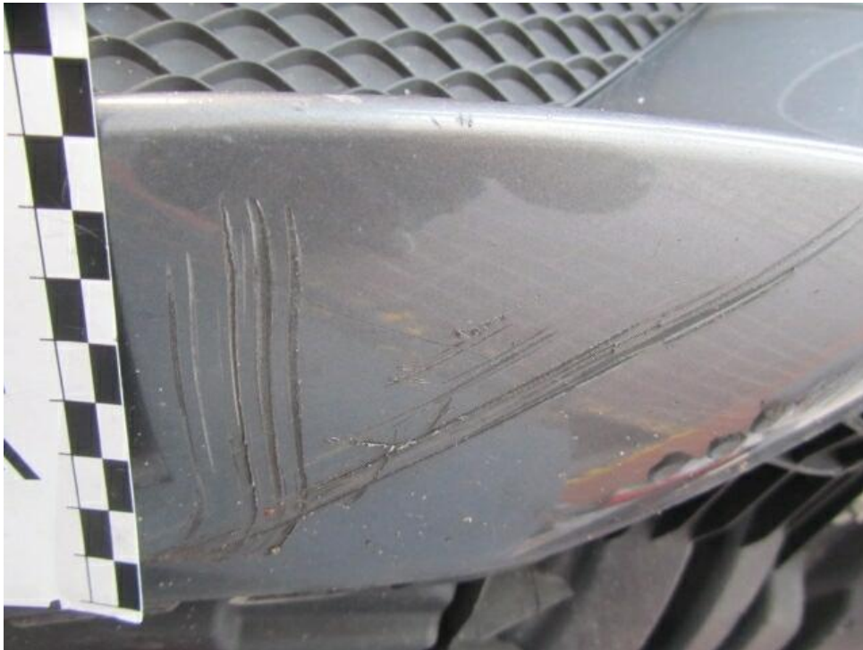
Bild 15 : Stoßfänger vorne Lackierung, verschrammt, smart repair
