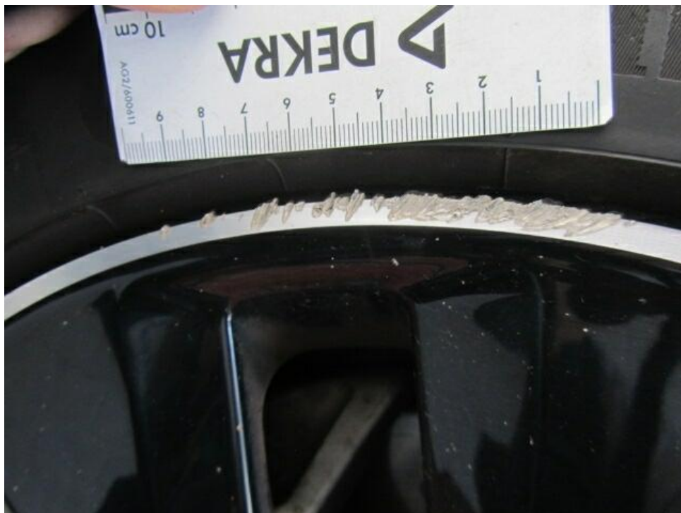
Bild 29 : Felge vorne rechts verschrammt glanzgedreht
