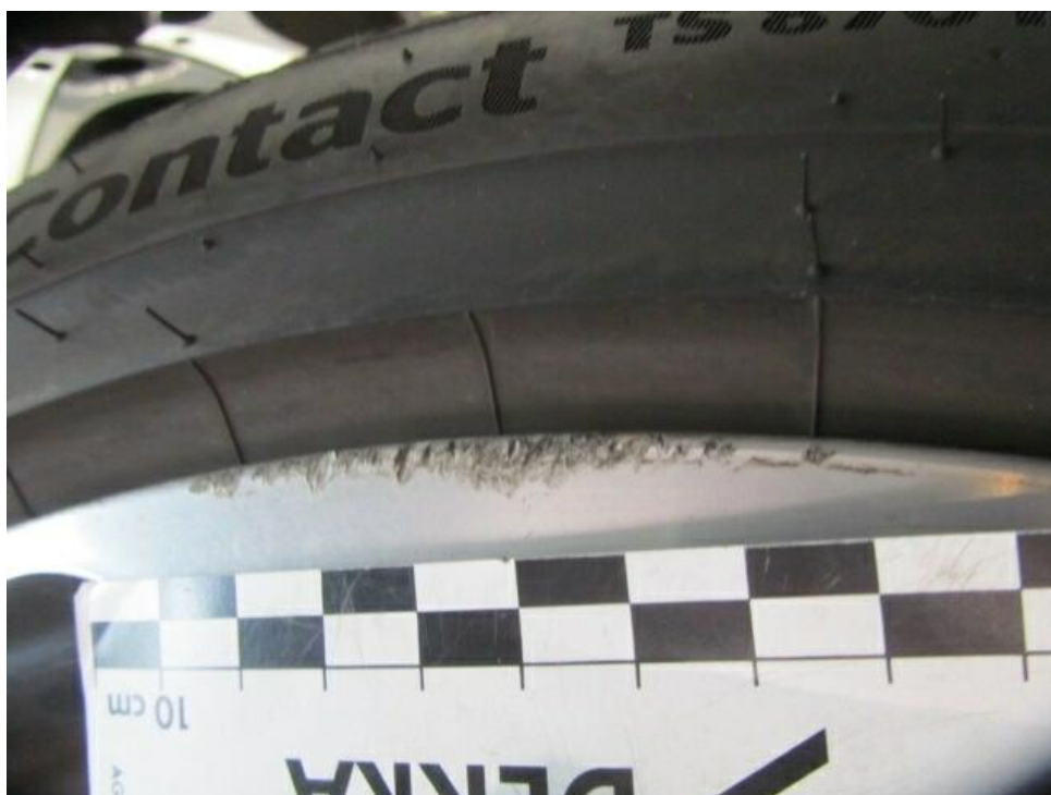
Bild 32 : Winterradsatz Felge hinten rechts verschrammt glanzgedreht
