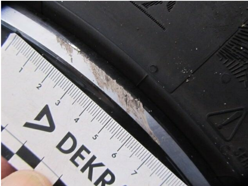
Bild 17 : Felge vorne links verschrammt glanzgedreht
