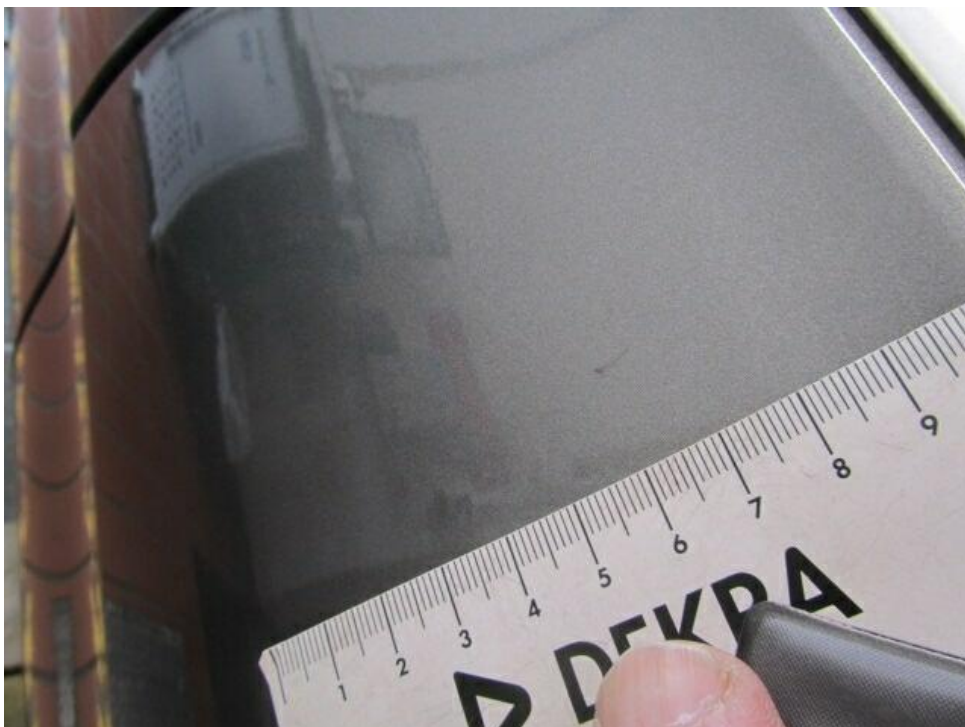
Bild 18 : Tür hinten links Lackierung unterhalb, verschrammt, lackieren mit Lackaufbau
