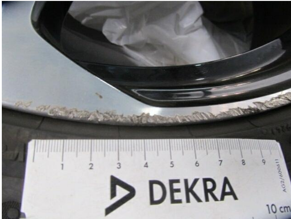
Bild 35 : Winterradsatz Felge vorne rechts verschrammt glanzgedreht
