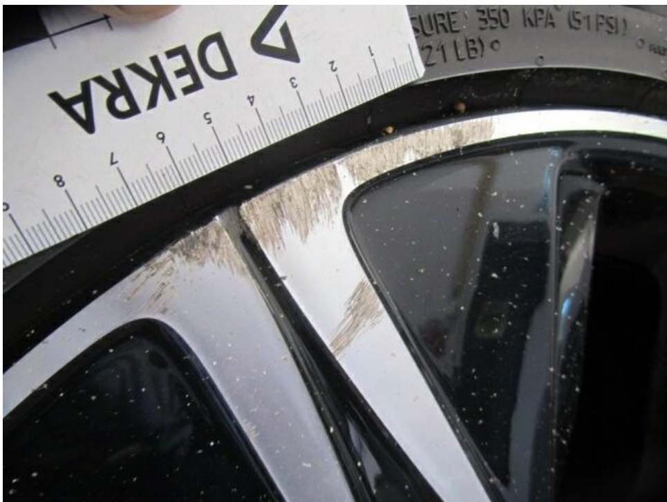
Bild 16 : Felge vorne links verschrammt glanzgedreht
