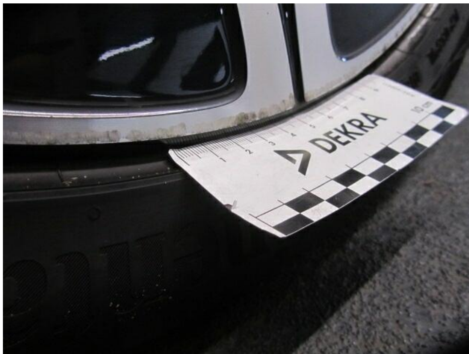
Bild 26 : Felge hinten rechts verschrammt glanzgedreht
