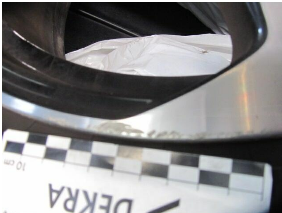
Bild 33 : Winterradsatz Felge hinten rechts verschrammt glanzgedreht
