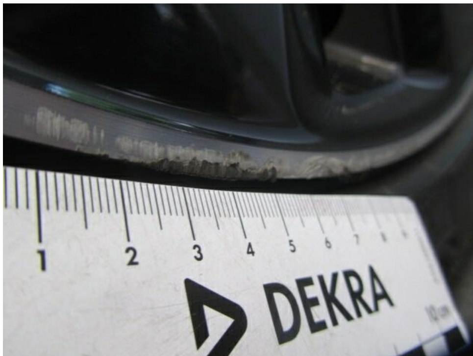
Bild 27 : Felge hinten rechts verschrammt glanzgedreht
