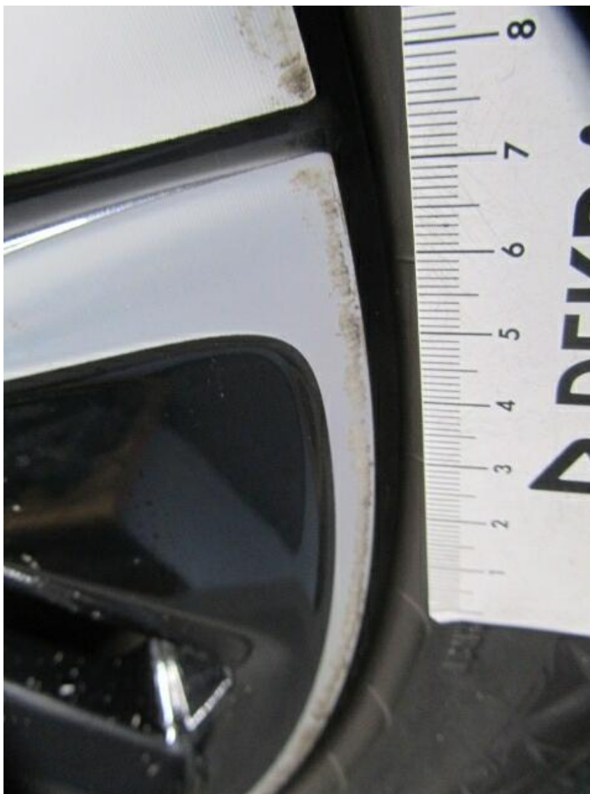
Bild 25 : Felge hinten rechts verschrammt glanzgedreht
