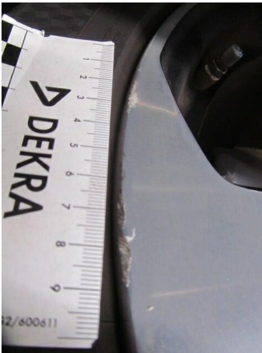
Bild 37 : Winterradsatz Felge vorne links verschrammt glanzgedreht
