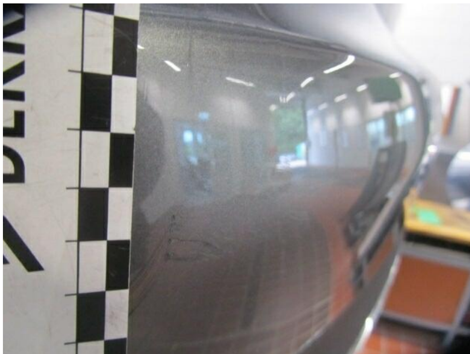
Bild 20 : Stoßfänger hinten, mehrfach eingedellt, instandsetzen und lackieren mit Lackaufbau
