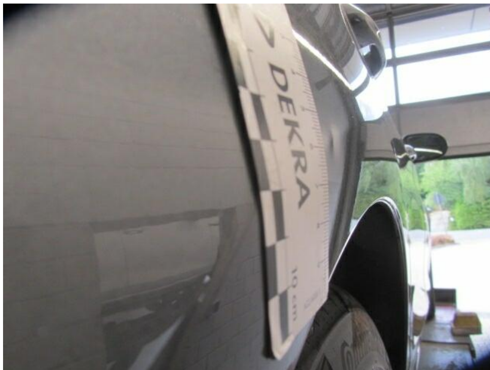
Bild 23 : Seitenteil hinten rechts, mehrfach eingedellt, drücken
