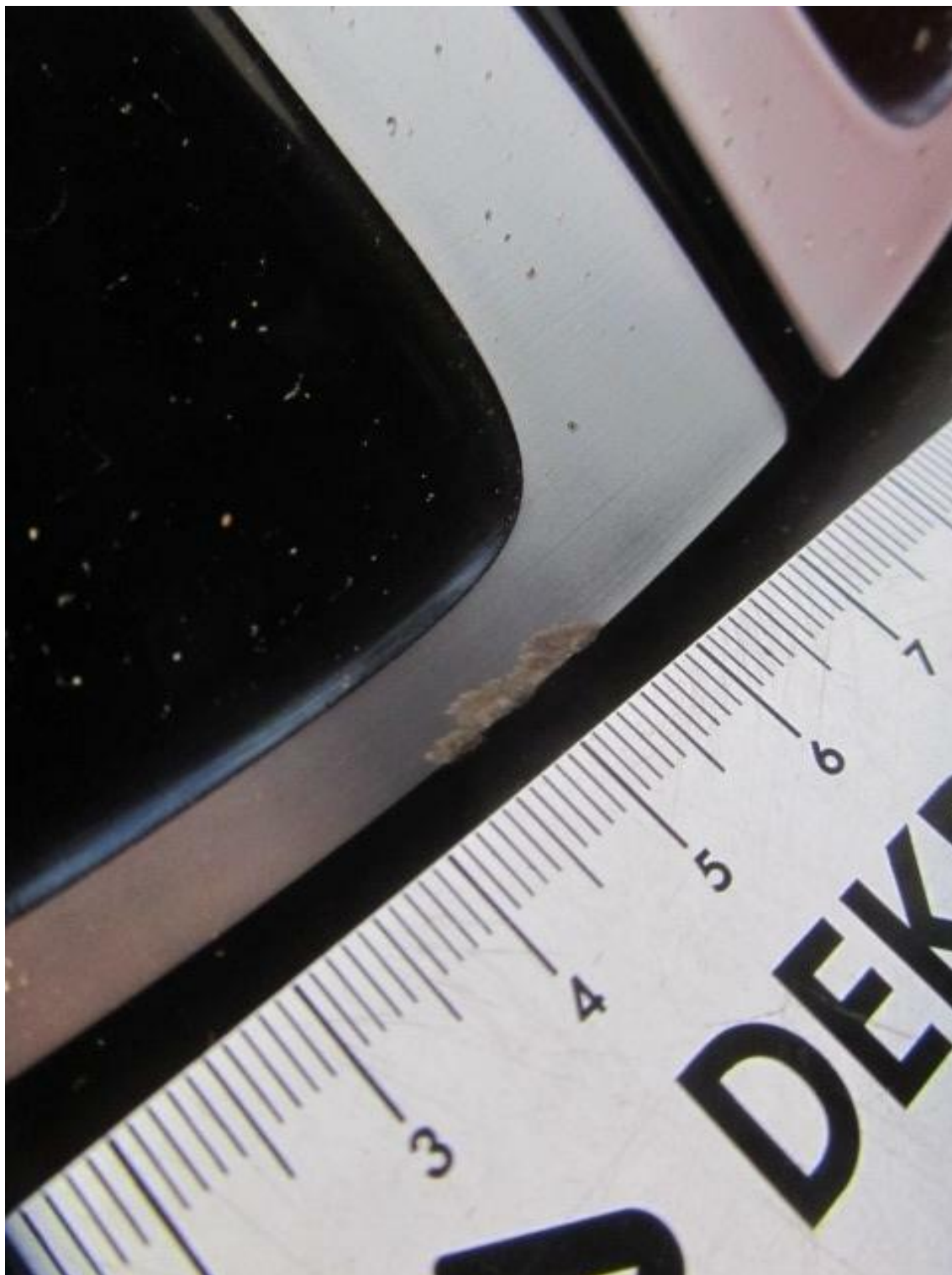
Bild 30 : Felge vorne rechts verschrammt glanzgedreht
