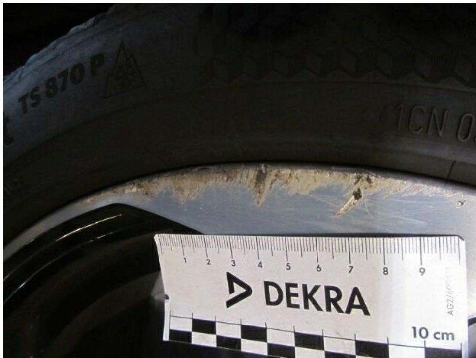
Bild 36 : Winterradsatz Felge vorne links verschrammt glanzgedreht
