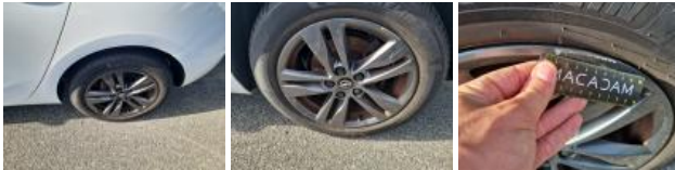
Alloy rim RL, Scratch(es), Repair/replace (lump sum)
