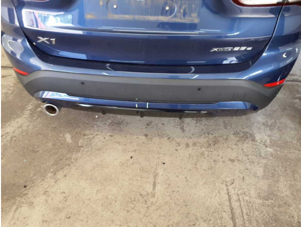
Beschädigung #1: Stossfänger hinten: Spoiler - Delle / Lackschaden - instandsetzen und lackieren
