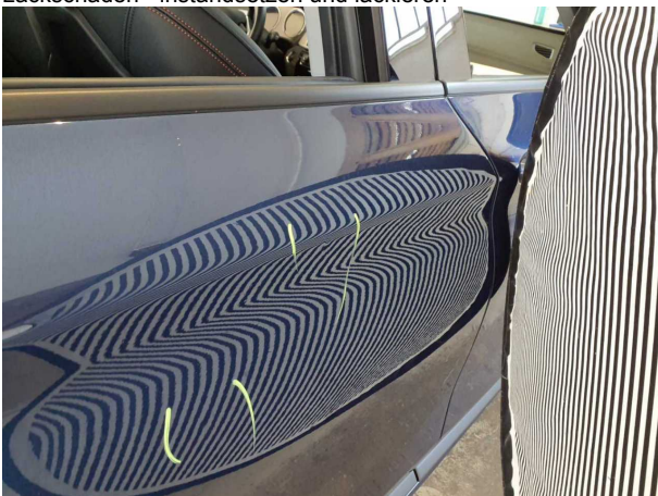
Beschädigung #2: Tür hinten rechts: Tür - Delle(n) - instandsetzen und lackieren
