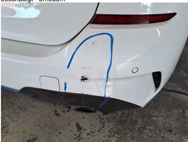
Beschädigung #11: Stossfänger hinten: Stossfänger hinten - beschädigt - erneuern
