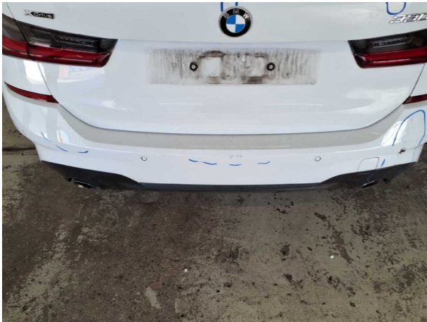
Beschädigung #11: Stossfänger hinten: Stossfänger hinten - beschädigt - erneuern
