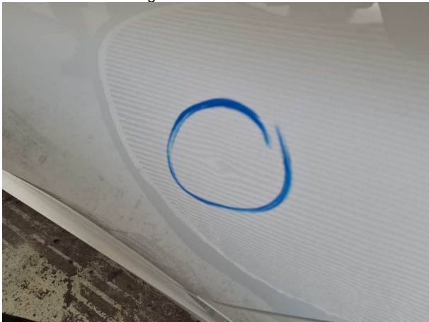
Beschädigung #4: Tür hinten links: Tür - Delle(n) - sanft instandsetzen
