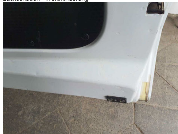
Beschädigung #6: Interieur: Laderaumunterteilung - Delle / Lackschaden - Wertminderung
