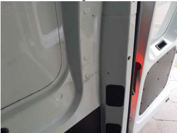
Beschädigung #6: Interieur: Laderaumunterteilung - Delle / Lackschaden - Wertminderung
