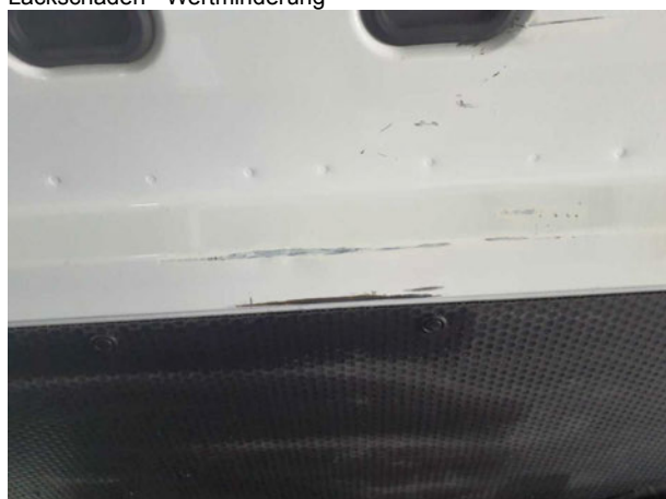
Beschädigung #6: Interieur: Laderaumunterteilung - Delle / Lackschaden - Wertminderung
