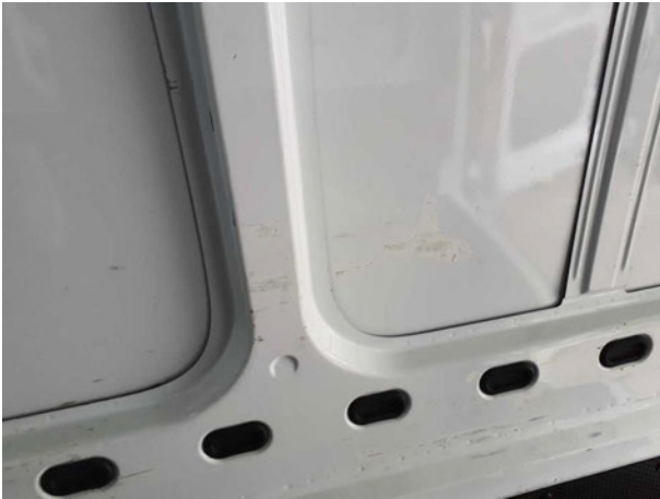
Beschädigung #6: Interieur: Laderaumunterteilung - Delle / Lackschaden - Wertminderung
