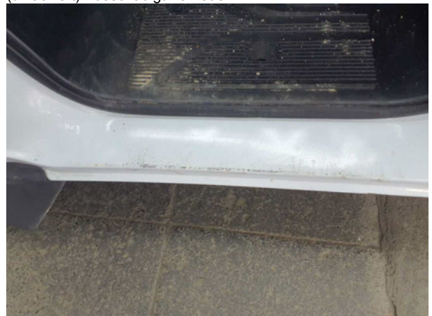
Beschädigung #9: Schweller links: Einstieg - Kratzer - lackieren
