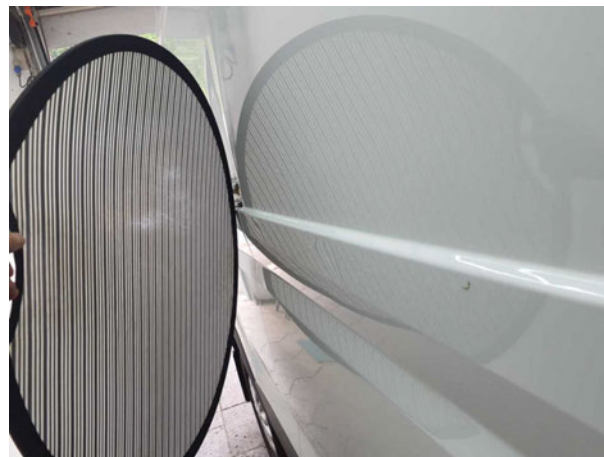
Beschädigung #1: Schiebetür rechts: Schiebetür - Delle(n) - sanft instandsetzen
