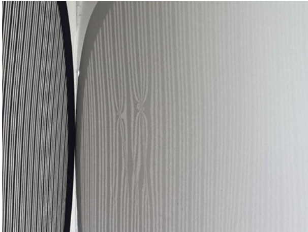
Beschädigung #3: Heckklappe/-tür: Hecktür rechts (& Links) - Delle(n) - Smart Repair
