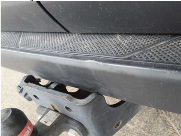
Beschädigung #8: Stossfänger hinten: Stossfänger hinten (unlackiert) - beschädigt - erneuern
