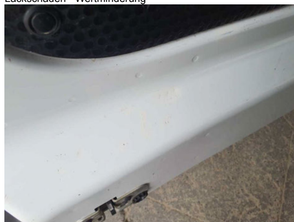
Beschädigung #6: Interieur: Laderaumunterteilung - Delle / Lackschaden - Wertminderung
