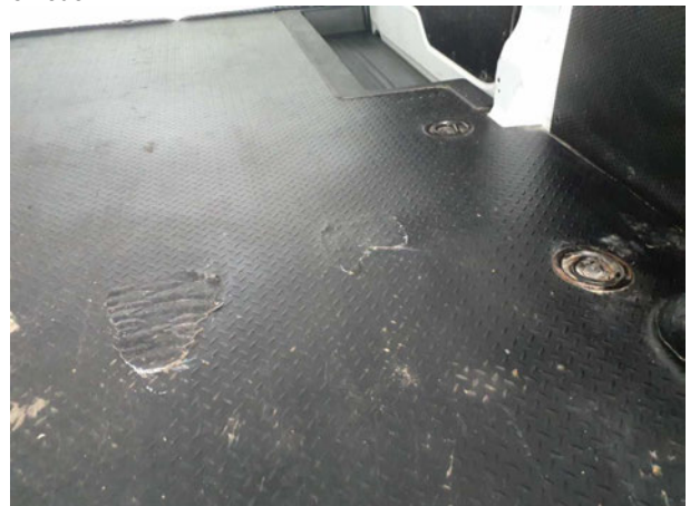
Beschädigung #11: Interieur: Laderaumboden - beschädigt - erneuern
