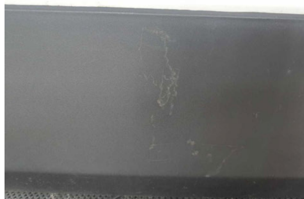
Beschädigung #2: Heckklappe/-tür: Hecktür rechts (Blende unten) - Kratzer - erneuern
