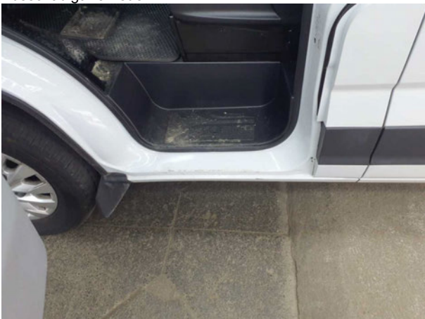
Beschädigung #9: Schweller links: Einstieg - Kratzer - lackieren
