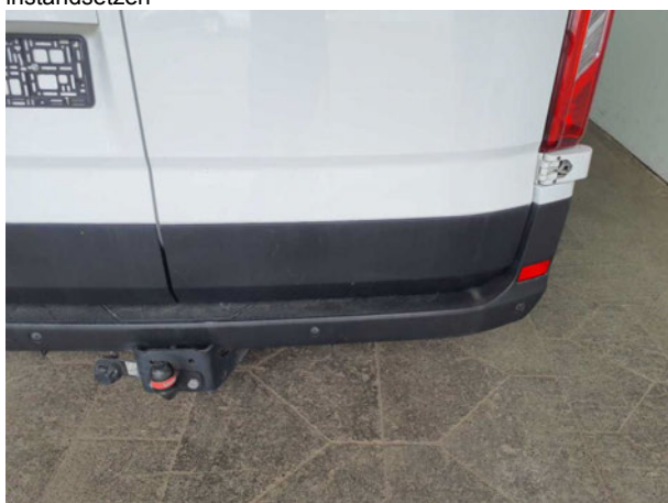
Beschädigung #2: Heckklappe/-tür: Hecktür rechts (Blende unten) - Kratzer - erneuern
