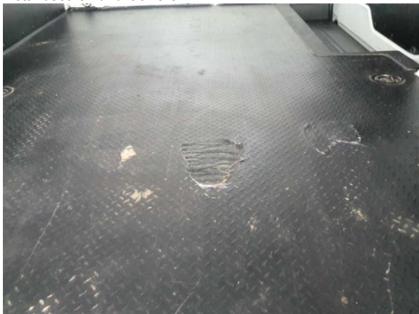
Beschädigung #11: Interieur: Laderaumboden - beschädigt - erneuern
