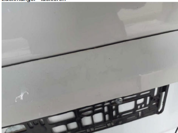
Beschädigung #5: Heckklappe/-tür: Hecktür links (Blende) - Lackmangel - lackieren
