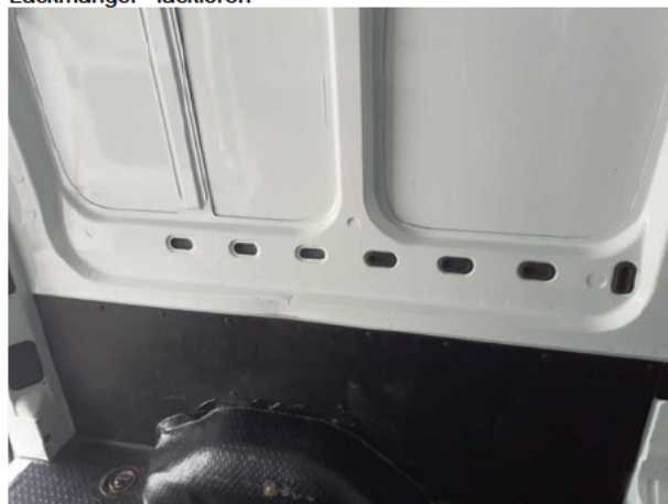
Beschädigung #6: Interieur: Laderaumunterteilung - Delle / Lackschaden - Wertminderung
