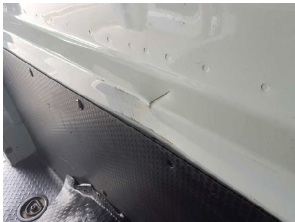
Beschädigung #6: Interieur: Laderaumunterteilung - Delle / Lackschaden - Wertminderung
