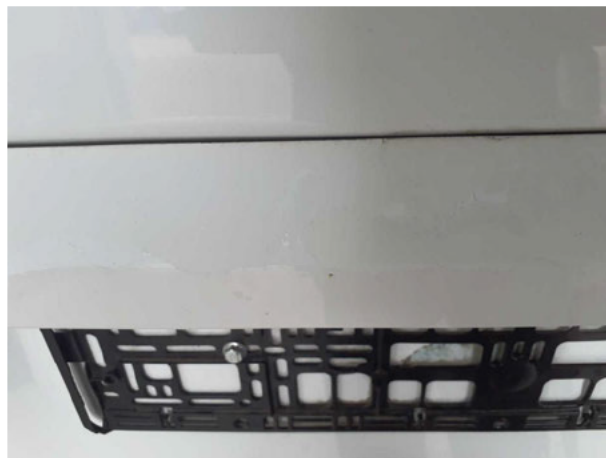
Beschädigung #5: Heckklappe/-tür: Hecktür links (Blende) - Lackmangel - lackieren
