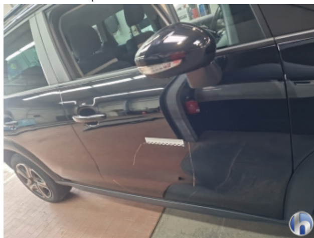
6. Tür Vorne - Rechts Unfallsschaden - Instandsetzen und Lackieren
