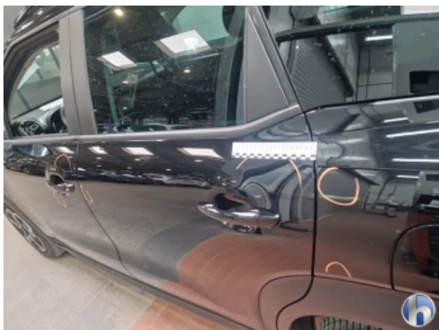
2. Tür Hinten - Links Beschädigt - Lackieren
