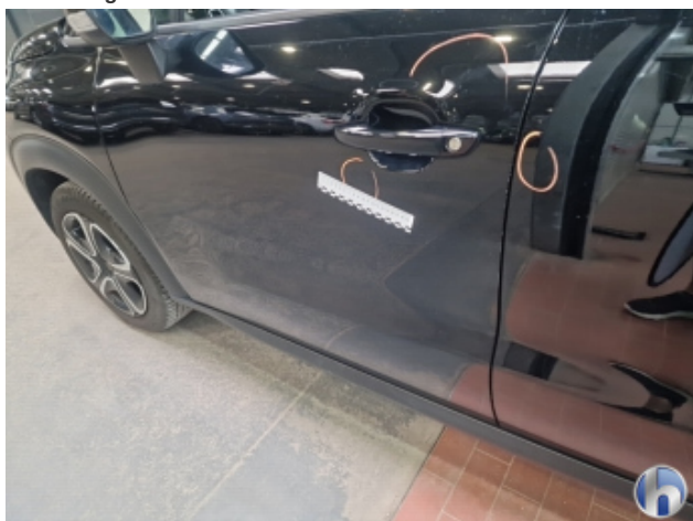
3. Tür Vorne - Links Beschädigt - Lackieren
