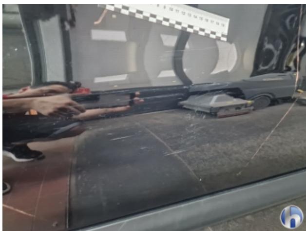
6. Tür Vorne - Rechts Unfallschaden - Instandsetzen und Lackieren
