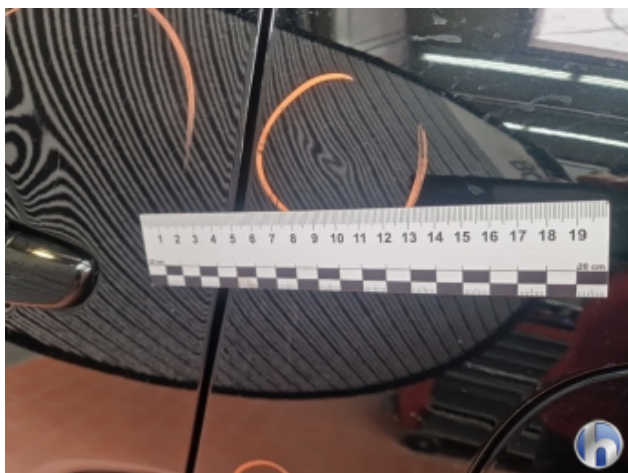
1. Seitenwand - Hinten - Links Delle - Lackieren
