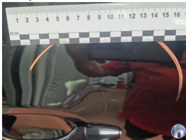
2. Tür Hinten - Links Beschädigt - Lackieren
