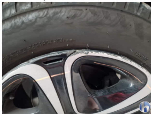
8. Felge Vorne - Rechts Beschädigt - Smart Repair
