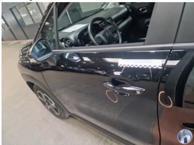
3. Tür Vorne - Links Beschädigt - Lackieren
