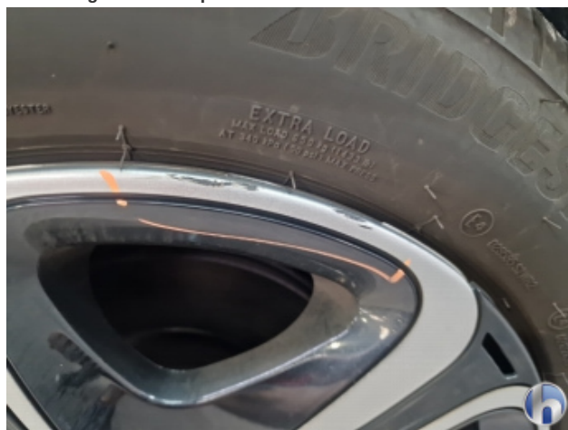
11. Felge Vorne - Links Beschädigt - Smart Repair
