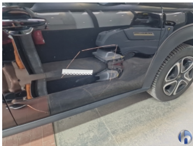
6. Tür Vorne - Rechts Unfallschaden - Instandsetzen und Lackieren
