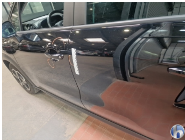
2. Tür Hinten - Links Beschädigt - Lackieren
