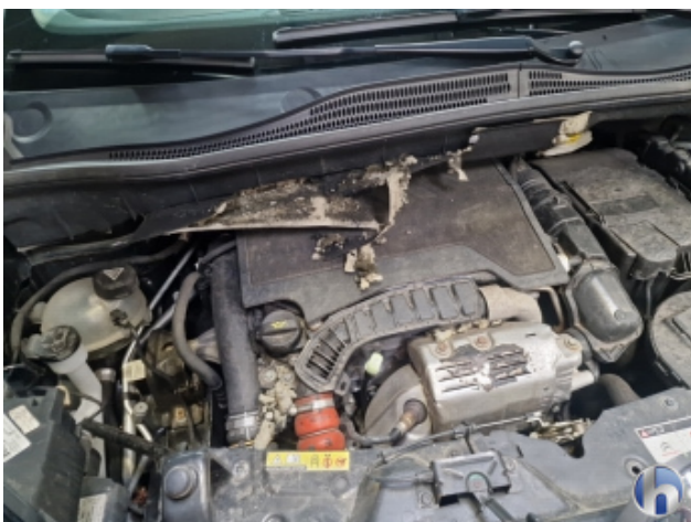
13. Motor Marderbiss /-schaden - Erneuern
