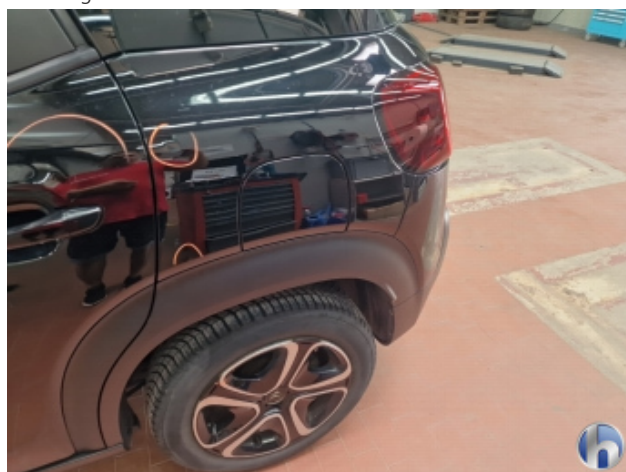
1. Seitenwand - Hinten - Links Delle - Lackieren
