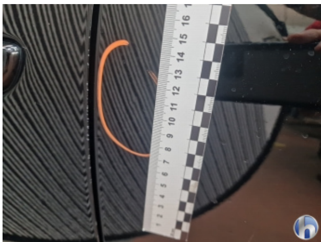
2. Tür Hinten - Links Beschädigt - Lackieren
