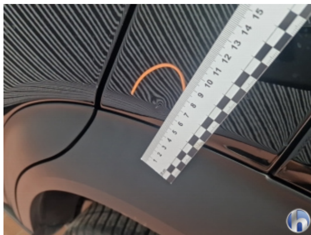
1. Seitenwand - Hinten - Links Delle - Lackieren
