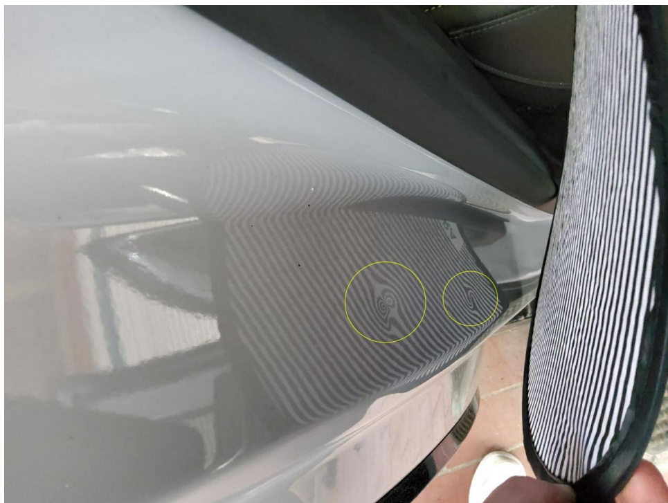
Bild 12 : Tür hinten rechts Einstieg, eingedellt, instandsetzen und lackieren mit Lackaufbau
