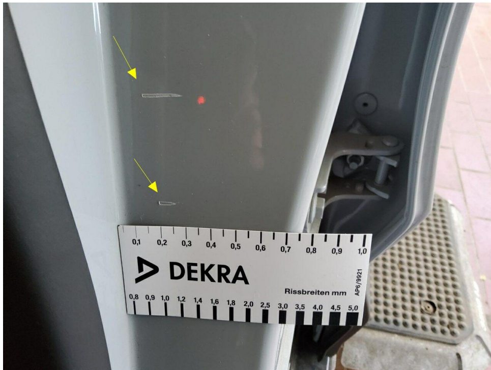
Bild 13 : Tür vorne links Einstieg Lackierung, verschrammt, lackieren mit Lackaufbau
