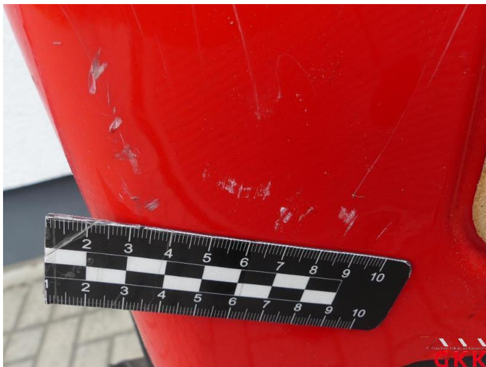
Bild 18. Hecktür links, innen, beschädigt, instand setzen - lackieren
