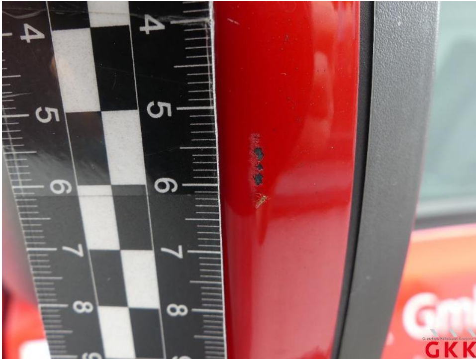
Bild 37. Spiegelgehäuse links, Kappe -lackiert-, verkratzt, auslegen, schleifen, polieren
