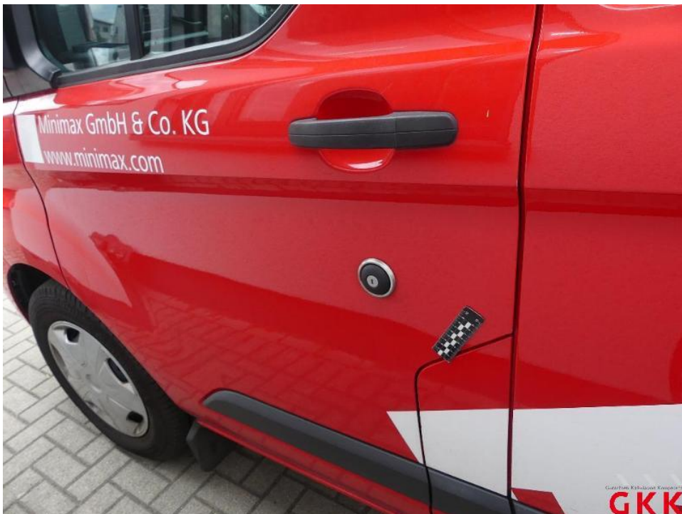
Bild 38. Tür vorne links, beschädigt, instand setzen - lackieren
