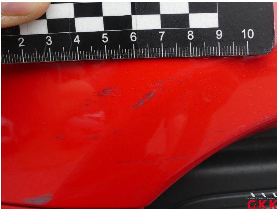
Bild 32. Stoßfänger vorne, Verkleidung oberhalb -lackiert-, verkratzt, lackieren
