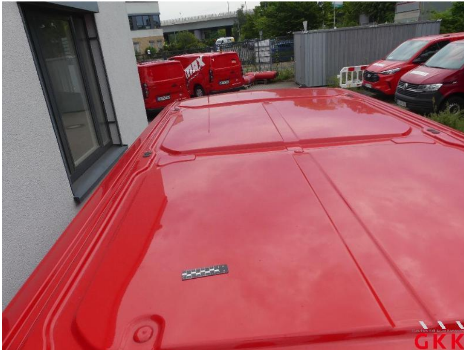
Bild 14. Dach, bis 3 Dellen / Bauteil, kalt drücken
