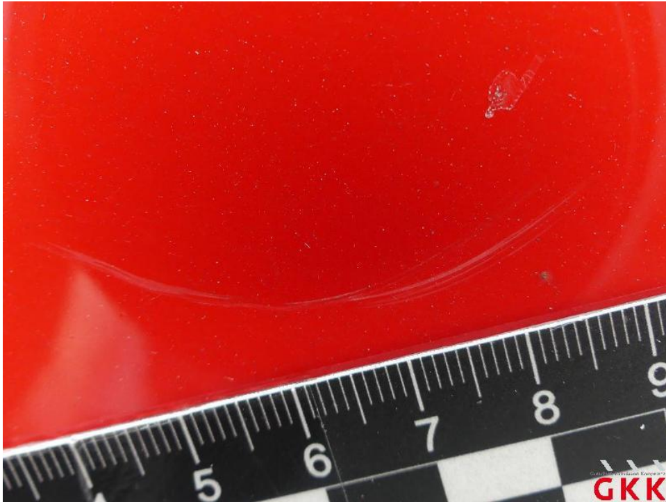
Bild 43. Seitenwand links, beschädigt, instand setzen - lackieren
