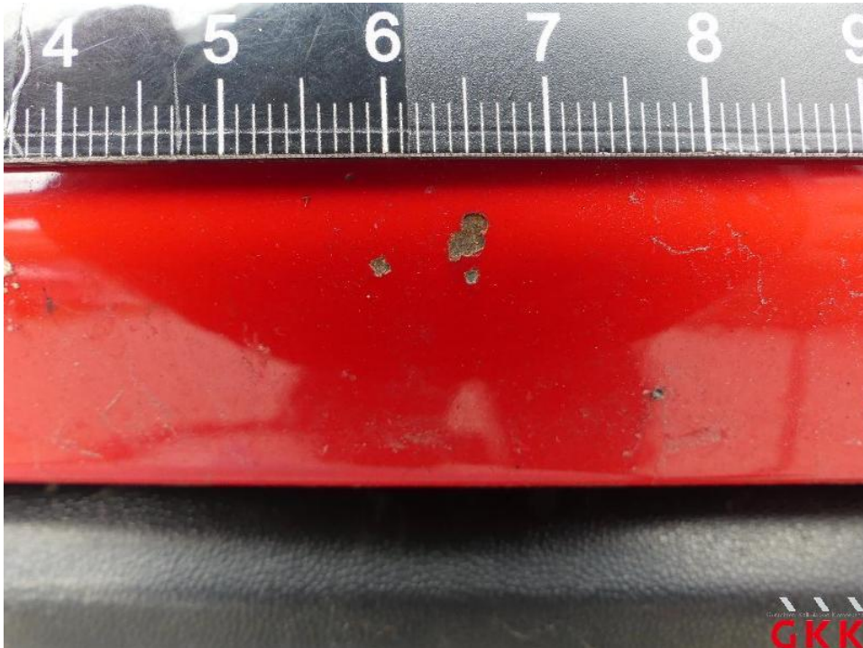
Bild 28. Motorhaube, Steinschlag, lackieren
