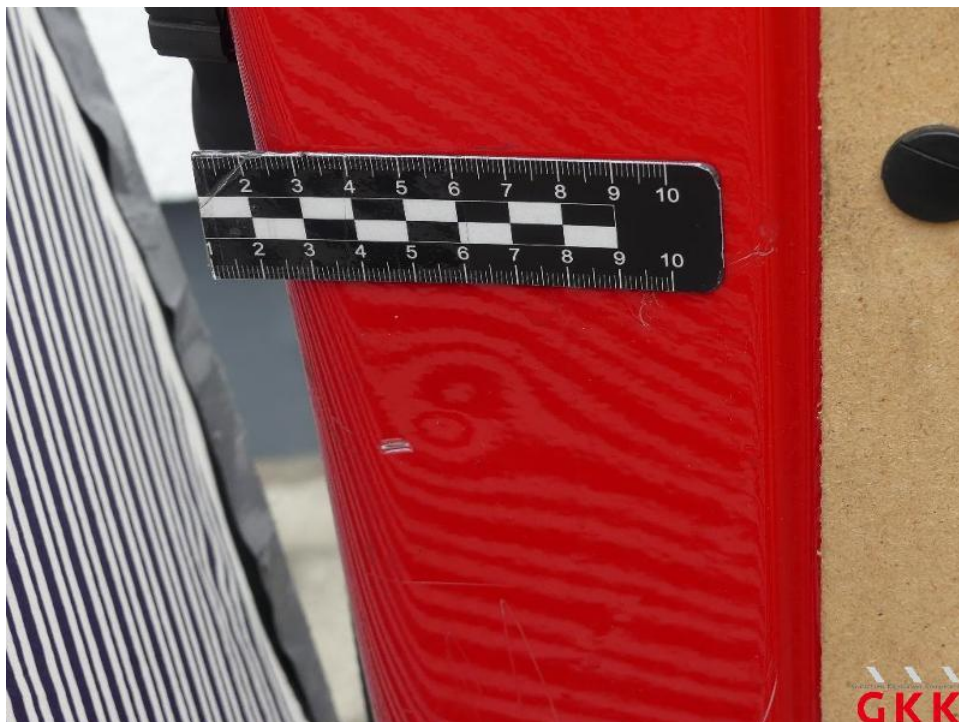
Bild 17. Hecktür links, innen, beschädigt, instand setzen - lackieren
