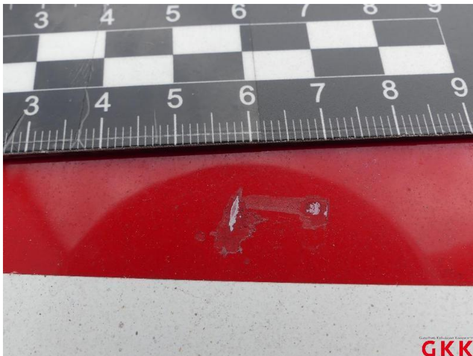
Bild 26. Hecktür rechts, beschädigt, instand setzen - lackieren
