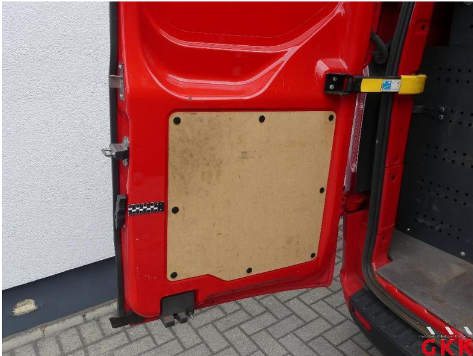
Bild 16. Hecktür links, innen, beschädigt, instand setzen - lackieren
