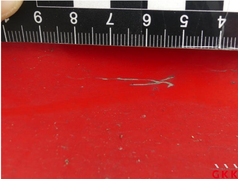
Bild 55. Tür vorne rechts, beschädigt, instand setzen - lackieren
