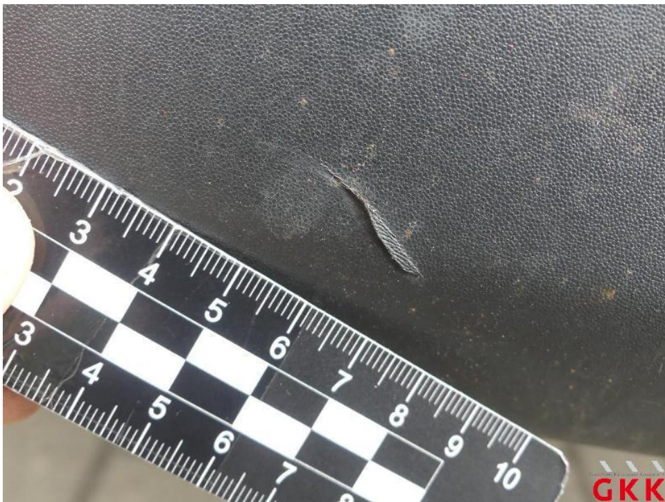
Bild 46. Stoßfänger hinten, Verkleidung -unlackiert-, verkratzt, ersetzen
