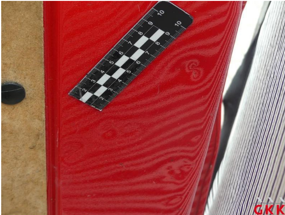
Bild 20. Hecktür rechts, innen, beschädigt, instand setzen - lackieren
