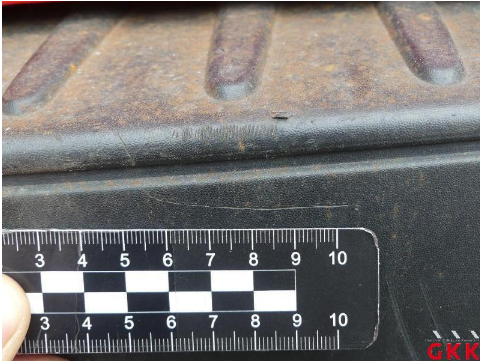
Bild 45. Stoßfänger hinten, Verkleidung -unlackiert-, verkratzt, ersetzen
