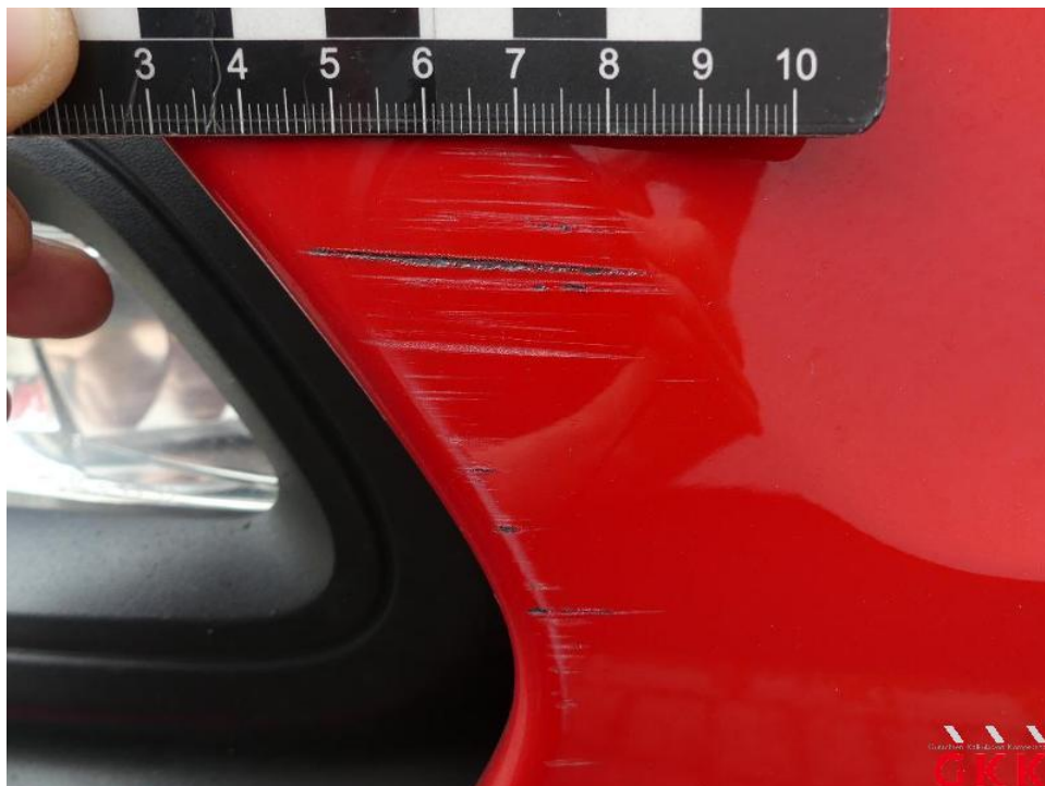
Bild 35. Stoßfänger vorne, Verkleidung unterhalb -lackiert-, verkratzt, lackieren
