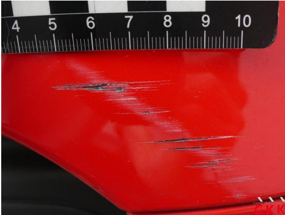
Bild 31. Stoßfänger vorne, Verkleidung oberhalb -lackiert-, verkratzt, lackieren
