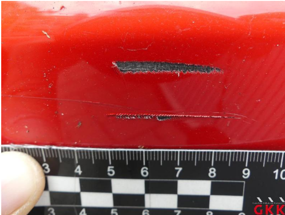
Bild 34. Stoßfänger vorne, Verkleidung unterhalb -lackiert-, verkratzt, lackieren
