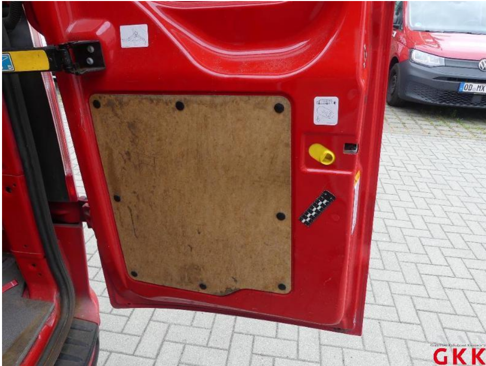
Bild 19. Hecktür rechts, innen, beschädigt, instand setzen - lackieren
