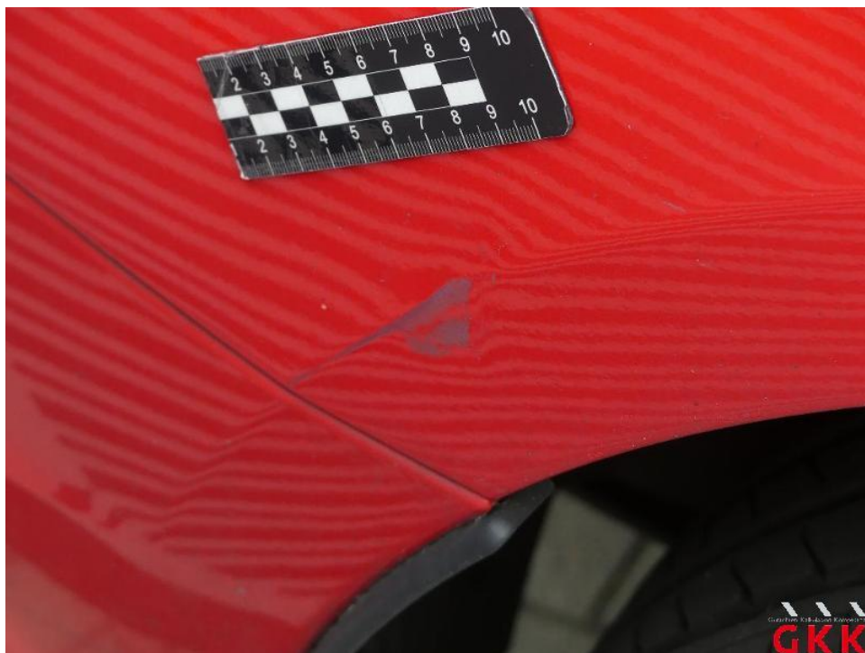
Bild 48. Seitenwand rechts, beschädigt, instand setzen - lackieren
