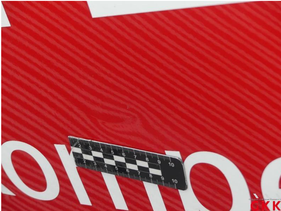
Bild 42. Seitenwand links, beschädigt, instand setzen - lackieren
