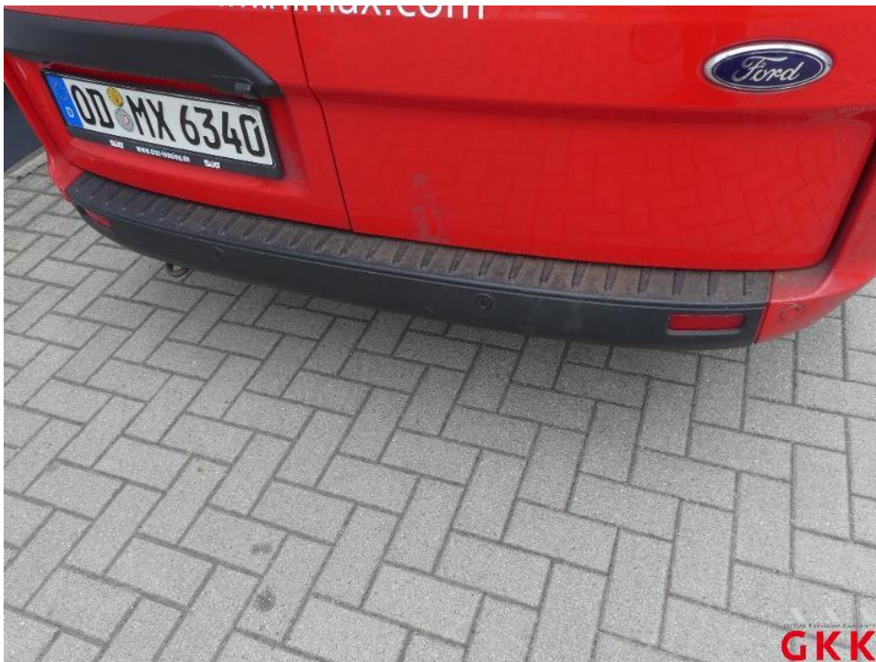
Bild 44. Stoßfänger hinten, Verkleidung -unlackiert-, verkratzt, ersetzen
