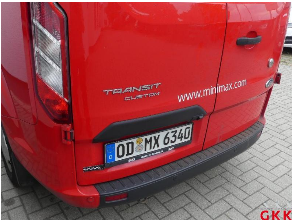
Bild 22. Hecktür links, verkratzt, lackieren
