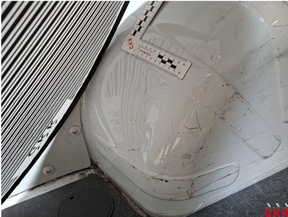
Bild 29 Radhaus hinten links, beschädigt, instand setzen - lackieren
