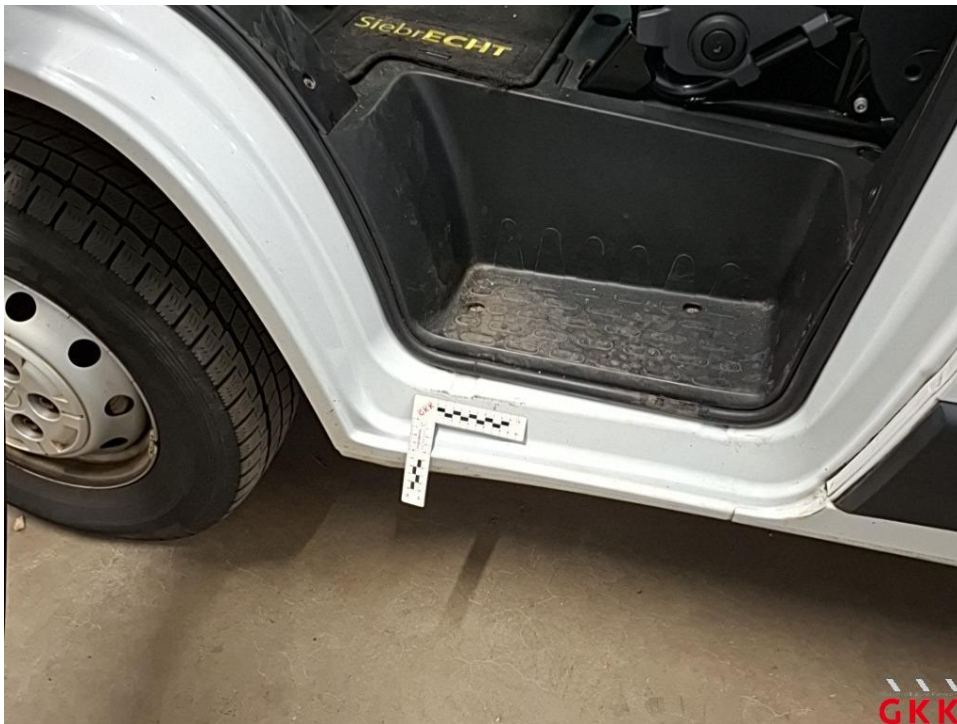
Bild 18 Tür vorne links, Einstieg, verkratzt, Smartrepair
