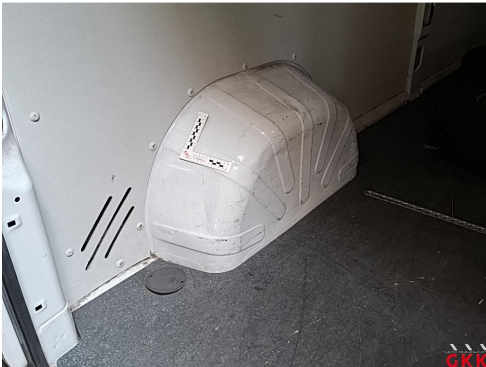
Bild 28 Radhaus hinten links, beschädigt, instand setzen - lackieren
