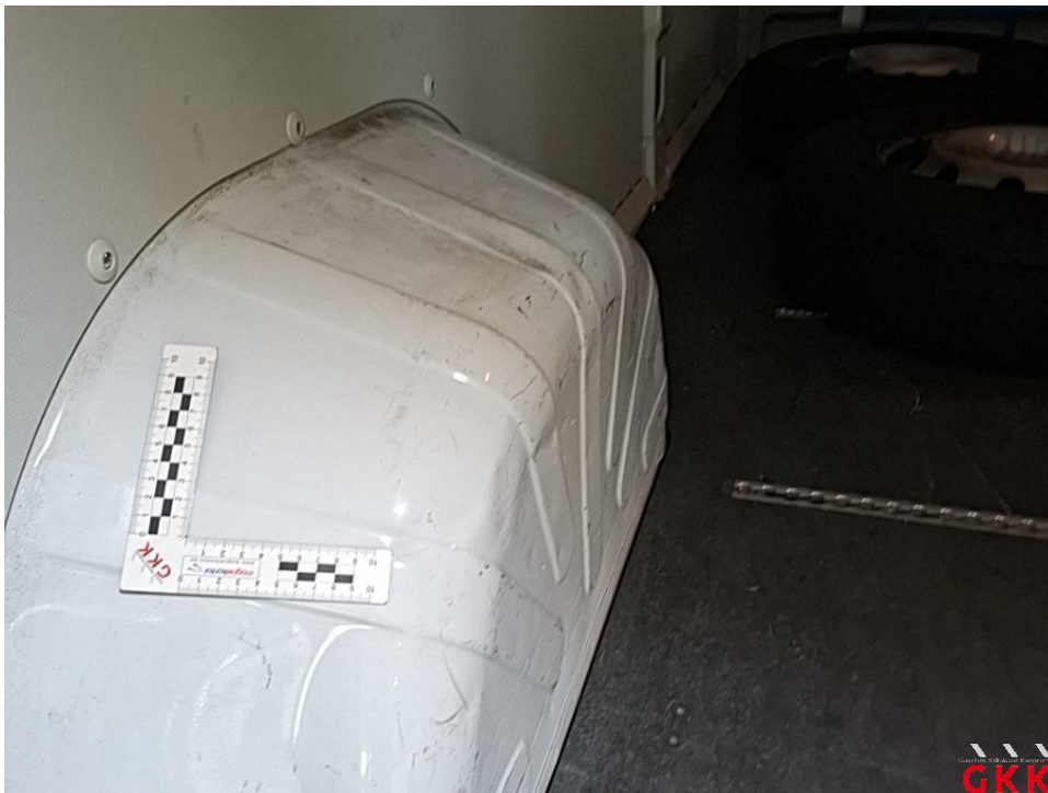
Bild 30 Radhaus hinten links, beschädigt, instand setzen - lackieren
