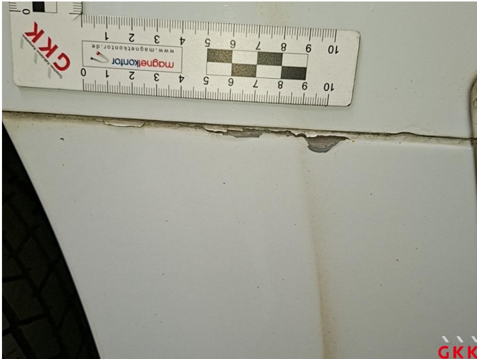
Bild 21 Seitenwand rechts, unterhalb, verkratzt, lackieren
