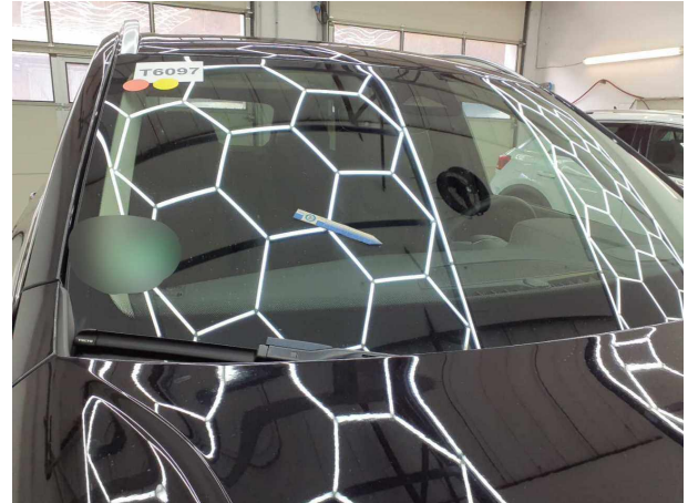
Beschädigung #1: Verglasung: Frontscheibe - Steinschlag - Smart Repair
