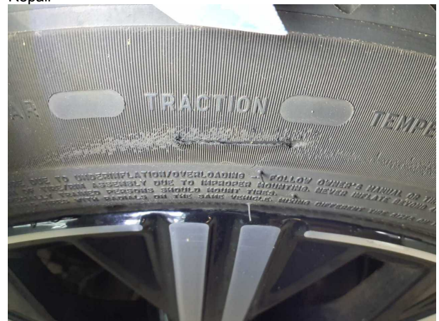
Beschädigung #2: Rad/Reifen: Reifen hinten links - beschädigt - erneuern
