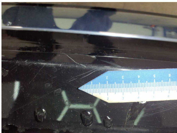
Beschädigung #3: Stossfänger hinten: Stossfänger hinten - Korrosio... lackieren
