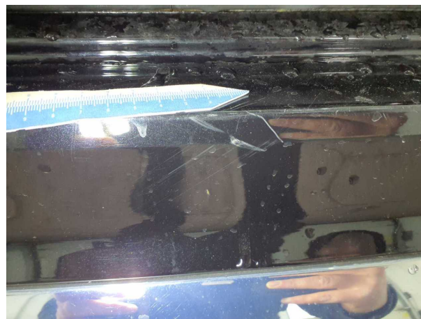
Beschädigung #3: Stossfänger hinten: Stossfänger hinten - Korrosion - lackieren
