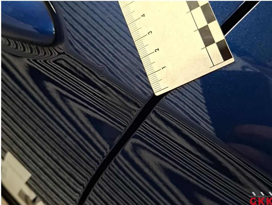
Bild 27 Tür vorne links, beschädigt, instand setzen - lackieren
