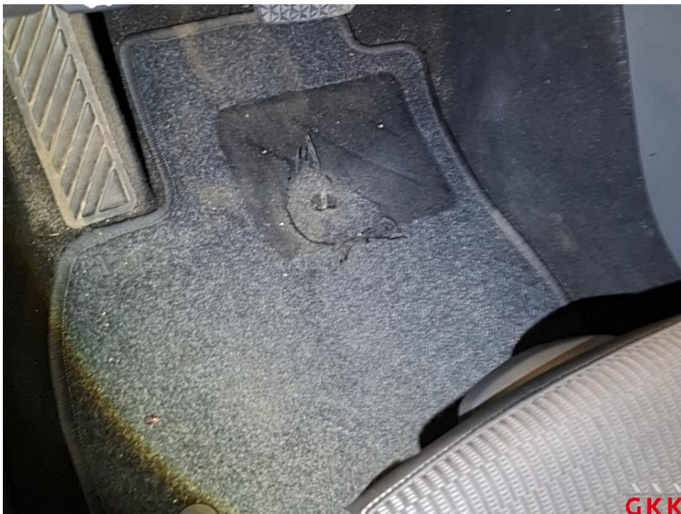
Bild 16 Fußmatte(n), vorne links, beschädigt, ersetzen
