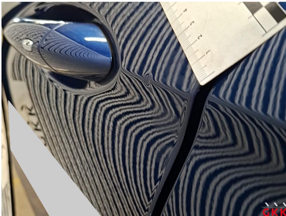
Bild 26 Tür vorne links, beschädigt, instand setzen - lackieren
