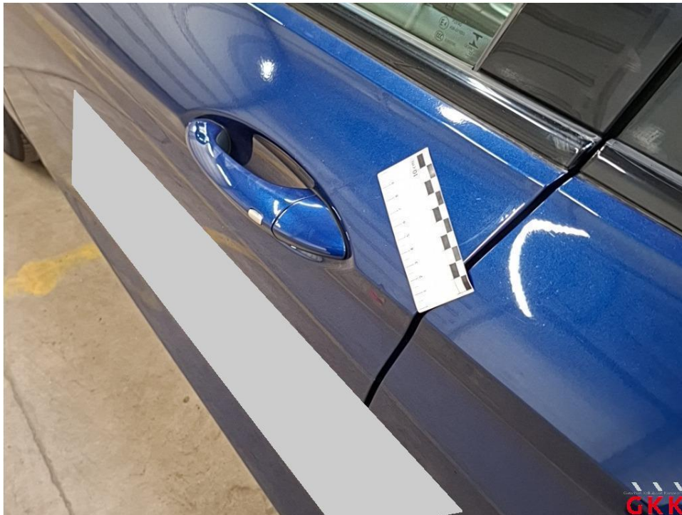
Bild 25 Tür vorne links, beschädigt, instand setzen - lackieren
