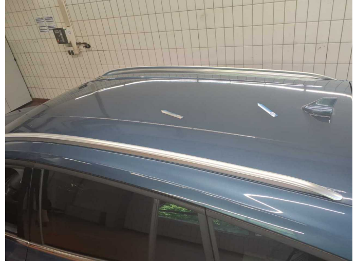
Damage 10: Roof: Roof (Verätzungen) - Paint defect - Paint
