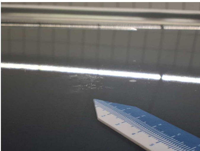
Damage 10: Roof: Roof (Verätzungen) - Paint defect - Paint
