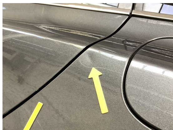
Bild 48: Karosserie / Fondseite links leicht deformiert
