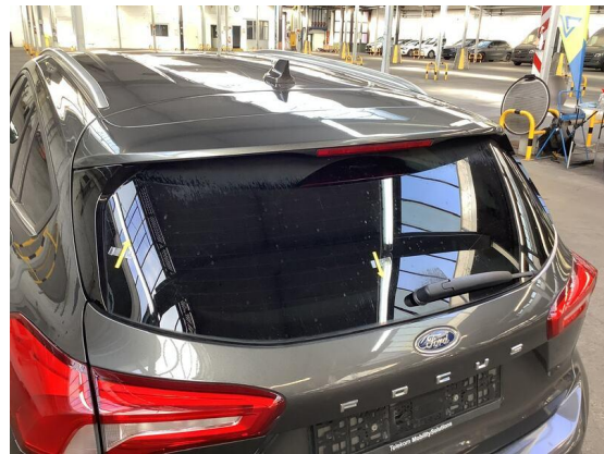
Bild 34: Karosserie / Heckscheibe verkratzt
