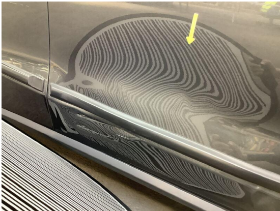
Bild 19: Karosserie / Tür vorne rechts stark deformiert
