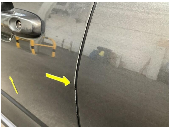
Bild 71: Karosserie / Tür vorne links zerkratzt
