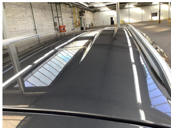
Bild 10: Wartung-Pflege / Lackzustand Lackoberfläche stumpf
