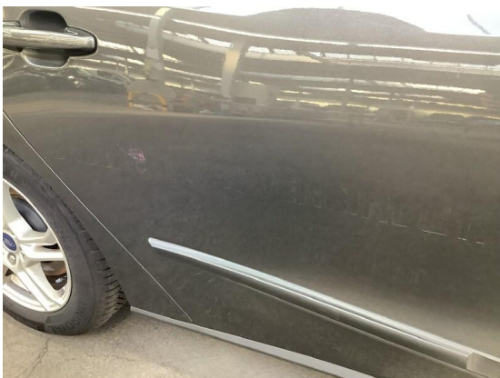
Bild 9: Wartung-Pflege / Lackzustand Lackoberfläche stumpf
