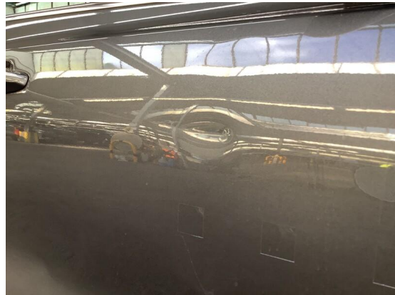
Bild 20: Karosserie / Tür vorne rechts stark deformiert
