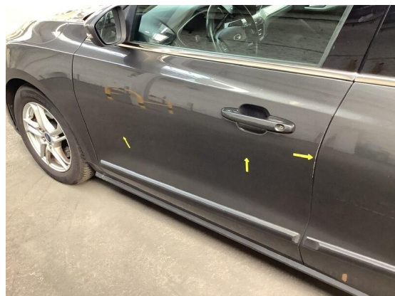
Bild 70: Karosserie / Tür vorne links zerkratzt
