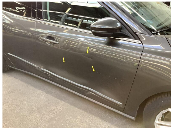
Bild 16: Karosserie / Tür vorne rechts stark deformiert
