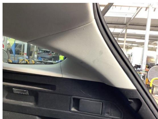
Bild 42: Innenraum / Kofferraumverkleidung rechts Kratzer
