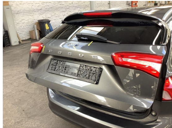
Bild 38: Karosserie / Heckklappe leicht deformiert
