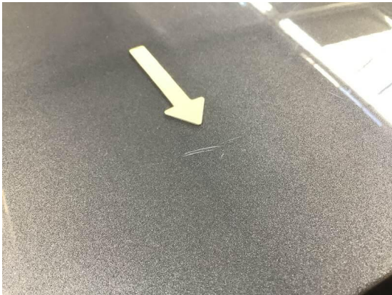
Bild 13: Karosserie / Dach zerkratzt
