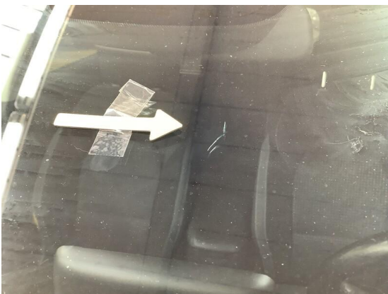
Bild 105: Karosserie / Windschutzscheibe gerissen
