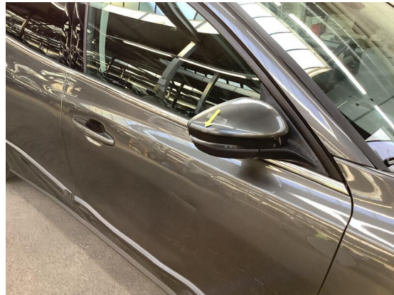
Bild 14: Karosserie / Spiegelkappe rechts zerkratzt
