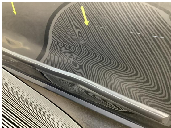
Bild 18: Karosserie / Tür vorne rechts stark deformiert
