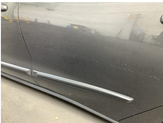
Bild 11: Wartung-Pflege / Lackzustand Lackoberfläche stumpf
