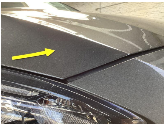
Bild 83: Karosserie / Motorhaube Steinschlag
