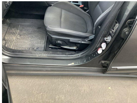
Bild 64: Karosserie / Einstieg vorne links Innenschweller beschädigt
