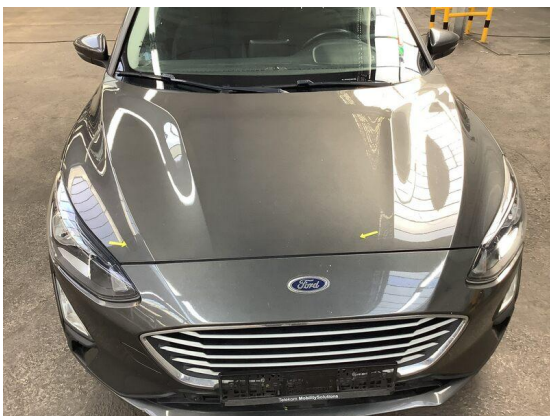
Bild 81: Karosserie / Motorhaube Steinschlag
