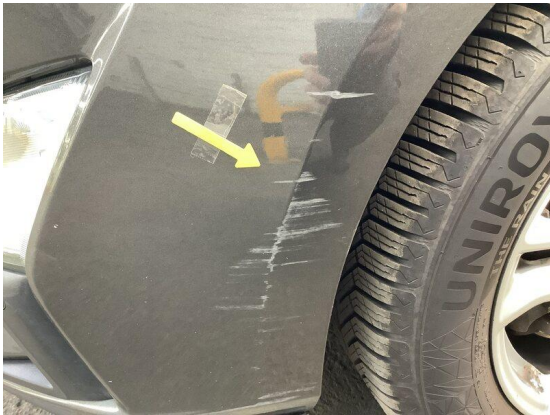
Bild 79: Karosserie / Stoßfänger vorne leicht deformiert
