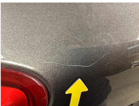
Bild 41: Karosserie / Heckklappe leicht deformiert
