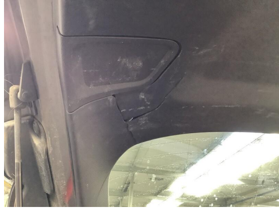
Bild 2: Innenraum / Heckklappeninnenverkleidung gebrochen
