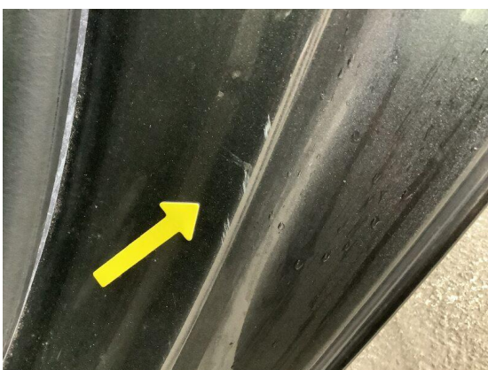
Bild 53: Karosserie / Einstieg hinten links Innenschweller beschädigt
