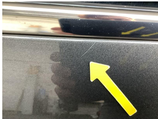
Bild 58: Karosserie / Tür hinten links leicht deformiert
