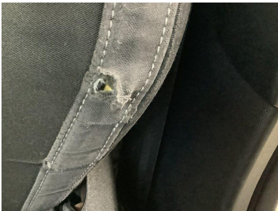
Bild 63: Innenraum / Sitzlehnenbezug vorne links beschädigt
