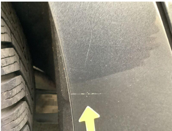
Bild 27: Karosserie / Fondseite rechts leicht deformiert
