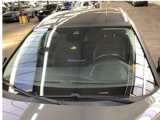
Bild 104: Karosserie / Windschutzscheibe gerissen
