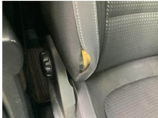
Bild 8: Innenraum / Sitzlehnenbezug vorne rechts beschädigt
