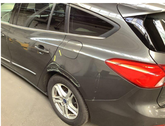
Bild 47: Karosserie / Fondseite links leicht deformiert
