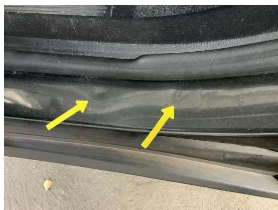
Bild 54: Karosserie / Einstieg hinten links Innenschweller beschädigt
