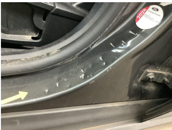
Bild 65: Karosserie / Einstieg vorne links Innenschweller beschädigt
