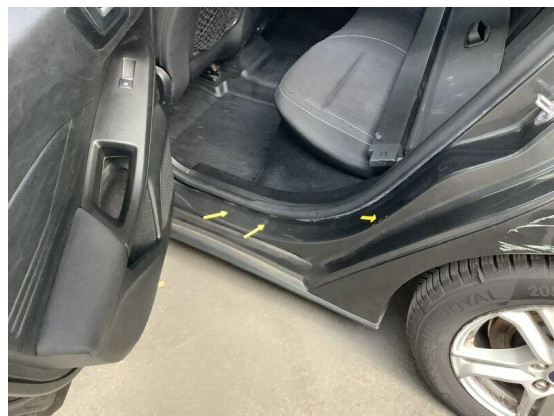
Bild 52: Karosserie / Einstieg hinten links Innenschweller beschädigt
