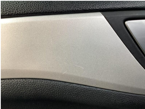
Bild 67: Innenraum / Türinnenverkleidung vorne links Kratzer
