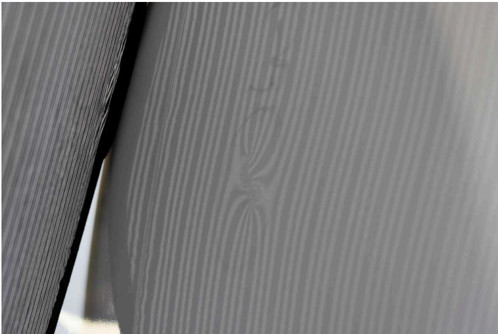
Bild 32 rechte Seite Schiebetür rechts Delle
