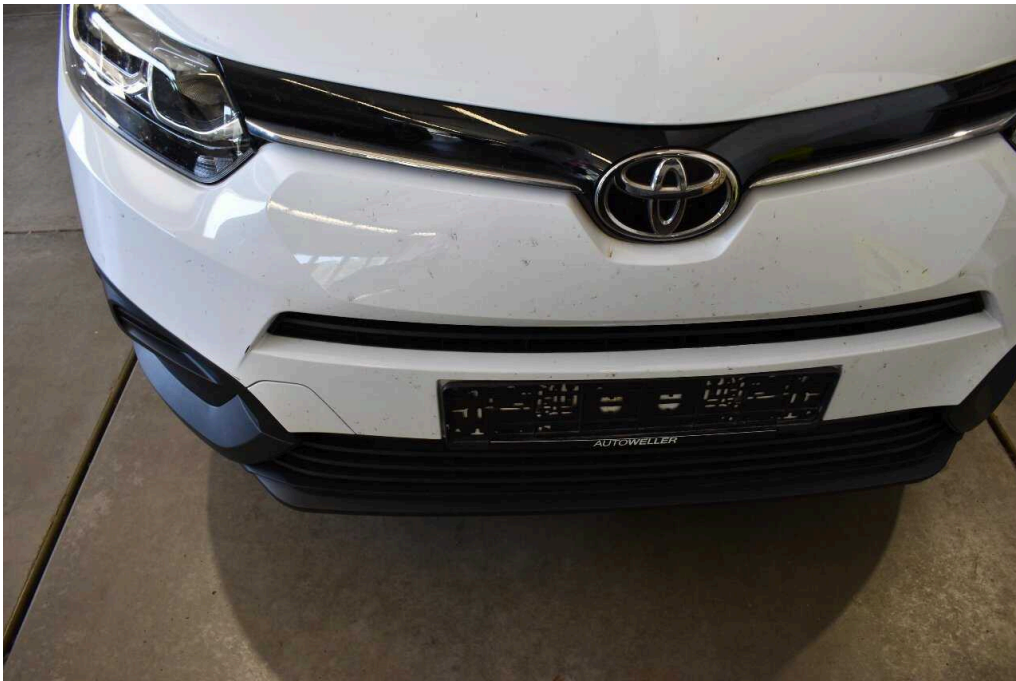
Bild 18 Fahrzeugfront Stoßfänger vorne Kratzer
