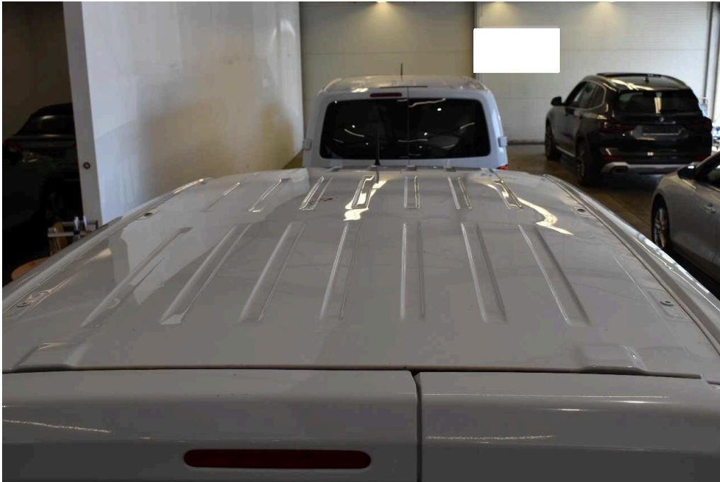
Bild 17 Dach Dachhaut Dellen
