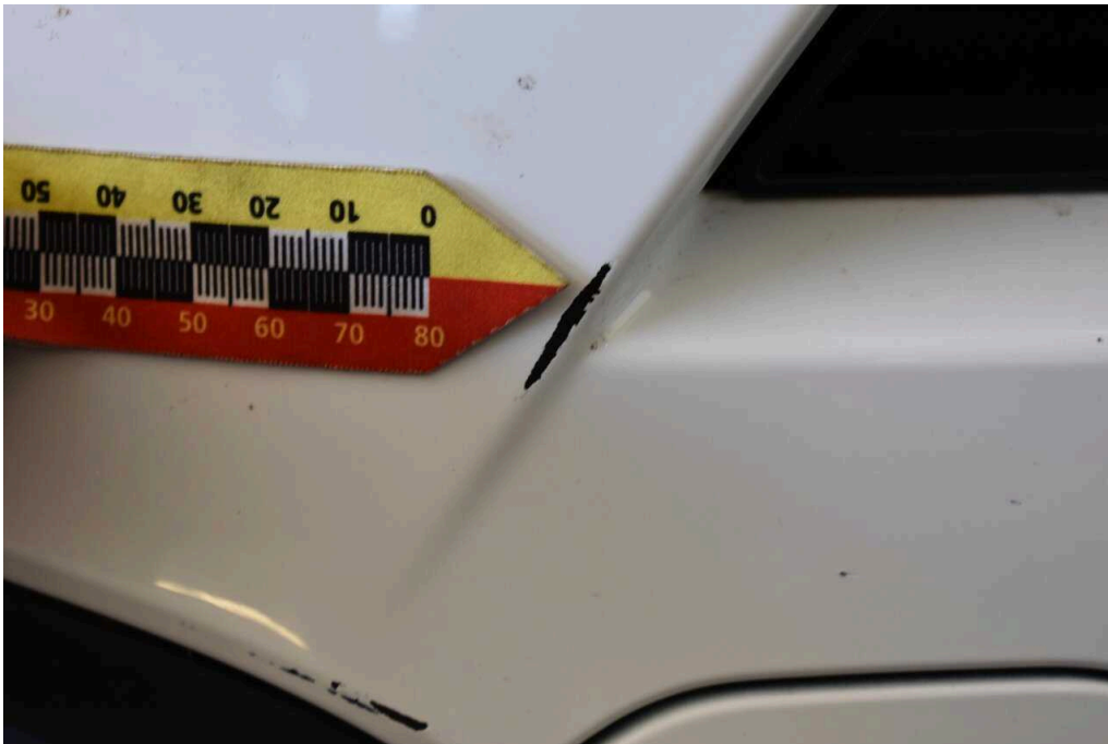
Bild 19 Fahrzeugfront Stoßfänger vorne Kratzer
