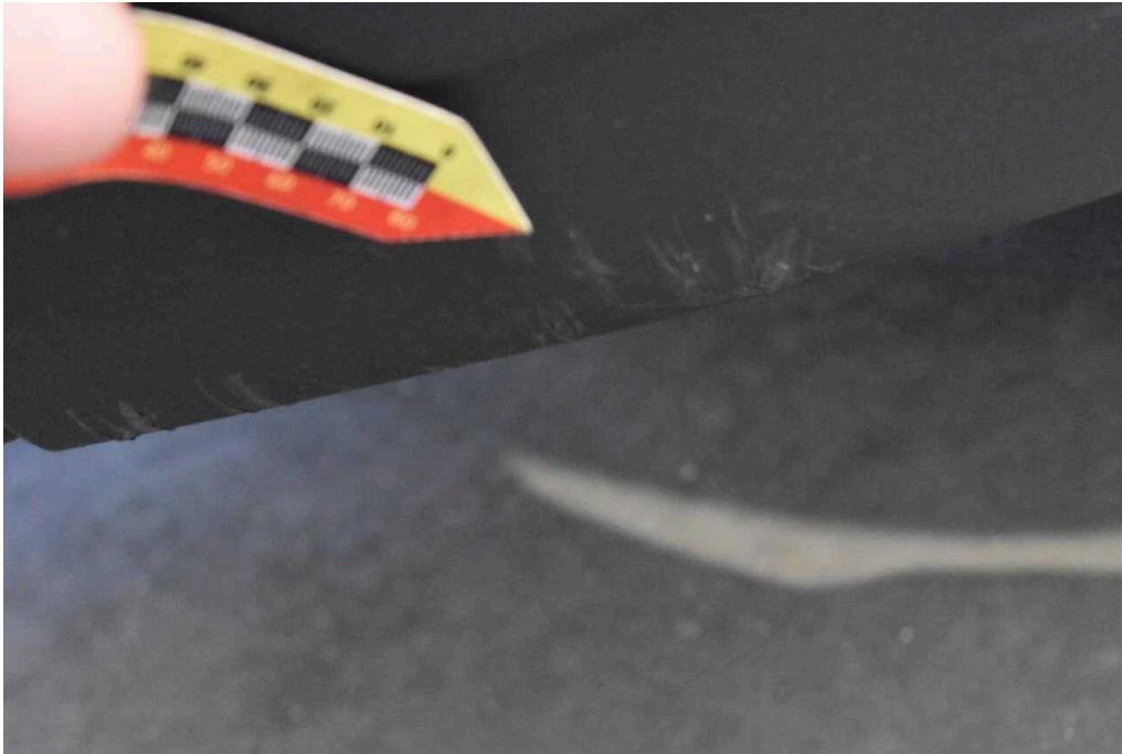
Bild 21 Fahrzeugfront Stoßfänger vorne Kratzer
