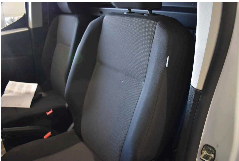
Bild 14 Innenraum Bezug Rückenlehne Fahrersitz Brandloch / Brandlöcher nicht reparabel
