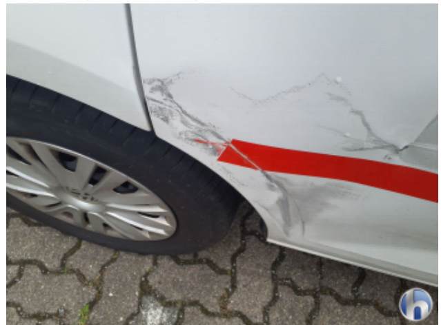
4. Tür Hinten - Rechts Unfallschaden - Siehe Kalkulation
