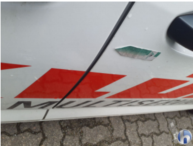
3. Tür Vorne - Rechts Gebrauchsspuren - Ohne Reparatur
