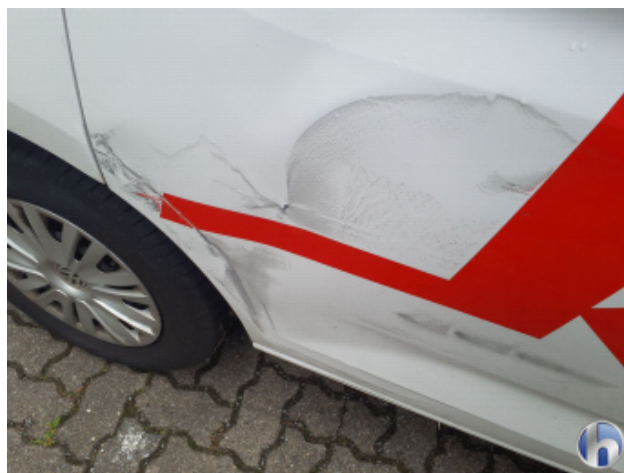
4. Tür Hinten - Rechts Unfallschaden - Siehe Kalkulation
