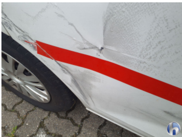
4. Tür Hinten - Rechts Unfallschaden - Siehe Kalkulation
