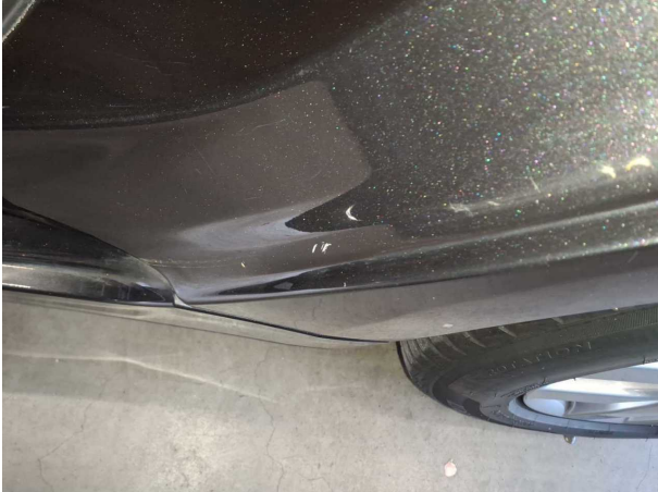
Beschädigung #1: Seitenwand links: Einstieg - Kratzer - Smart Repair
