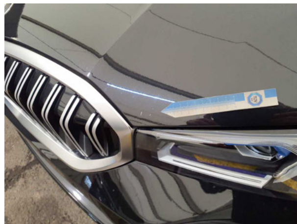
Beschädigung #1: Motorhaube: Motorhaube - Steinschlag - auslegen / polieren
