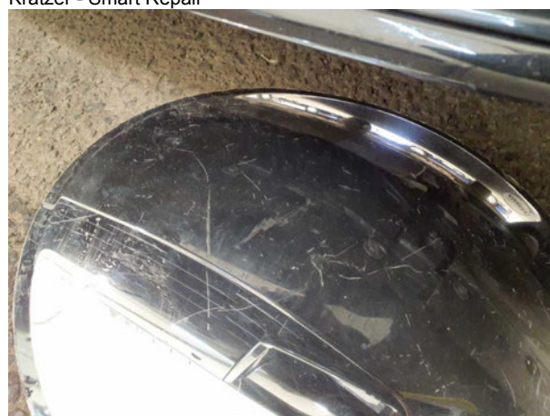
Beschädigung #3: Stossfänger vorn: Stossfänger vorn (Unterhalb verkratzt.) - verkratzt / verschürft - Smart Repair
