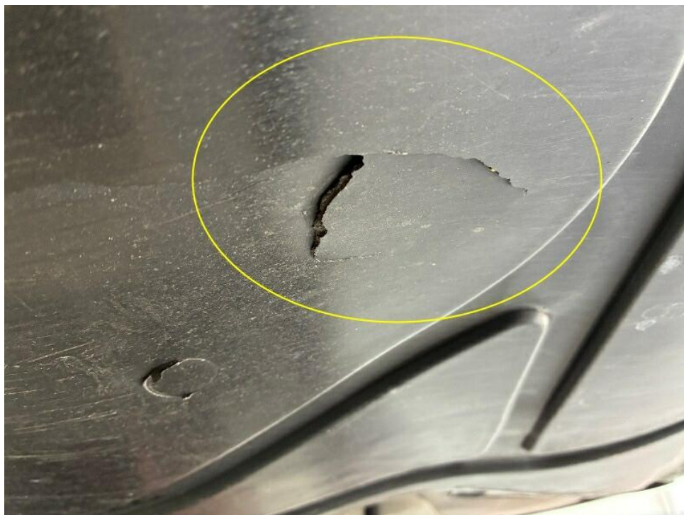
Bild 28 : Unterbodenverkleidung Motor, gebrochen, erneuern
