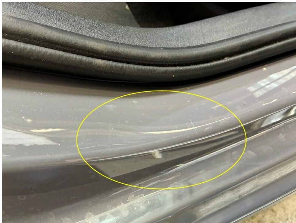
Bild 22 : Tür hinten rechts Einstieg Lackierung, zerkratzt, Gebrauchsspur
