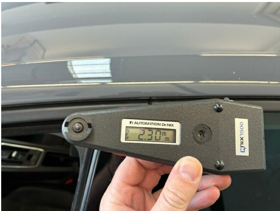
Bild 16 : Dachrahmen links, nicht fachgerecht instandgesetzt, instandsetzten und lackieren mit Lackaufbau
