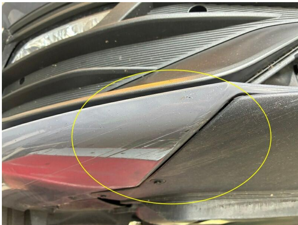
Bild 25 : Spoiler vorn, zerkratzt und ausgeclipst, erneuern
