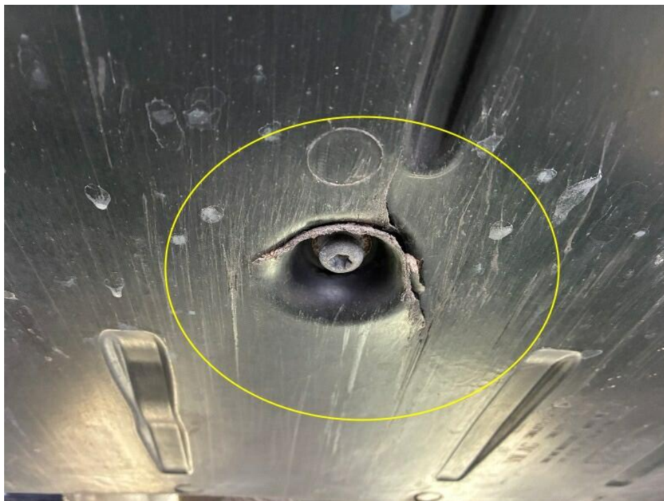
Bild 27 : Unterbodenverkleidung Motor, gebrochen, erneuern
