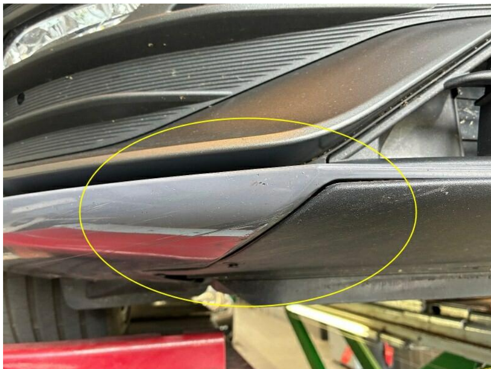
Bild 26 : Spoiler vorn, zerkratzt und ausgeclipst, erneuern
