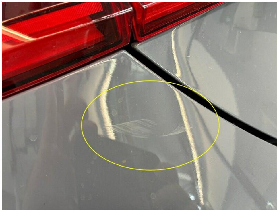
Bild 17 : Stoßfänger hinten Lackierung, zerkratzt, smart repair
