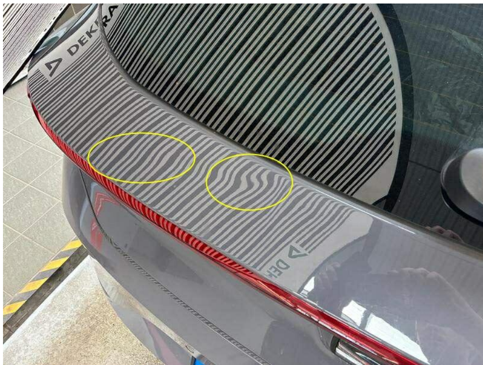
Bild 19 : Heckdeckel, mehrfach eingedellt, drücken
