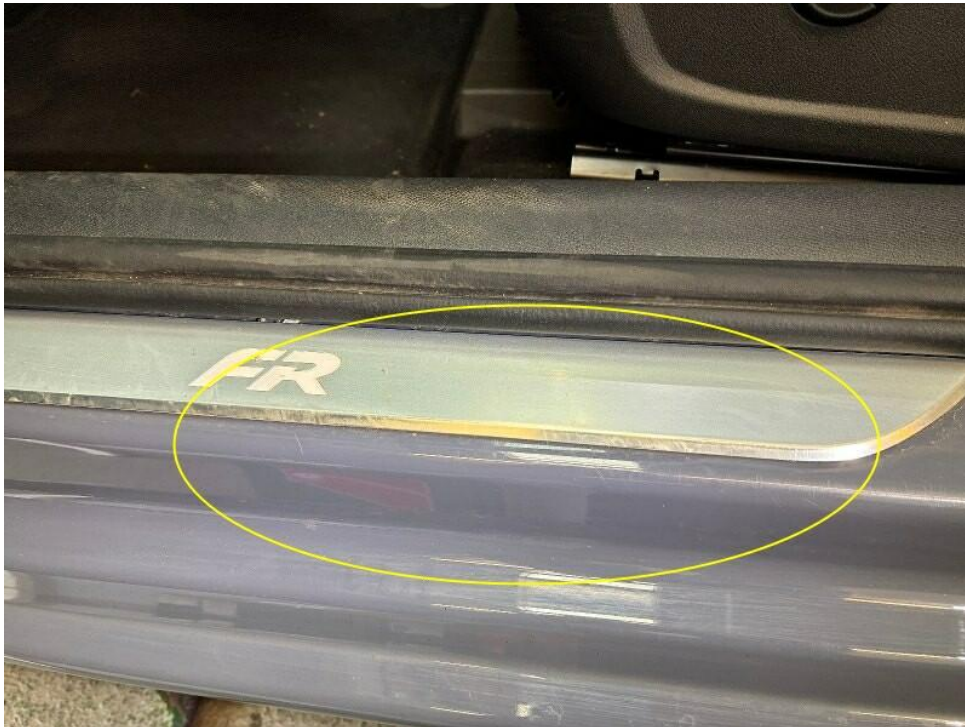
Bild 15 : Tür vorne links Einstieg Lackierung, zerkratzt, Gebrauchsspur
