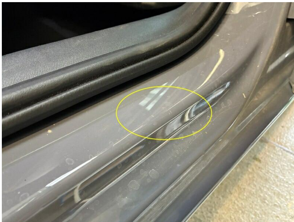
Bild 23 : Tür hinten rechts Einstieg Lackierung, zerkratzt, Gebrauchsspur
