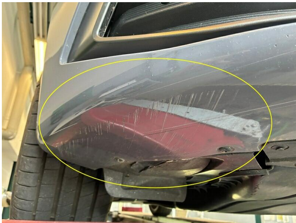
Bild 24 : Spoiler vorn, zerkratzt und ausgeclipst, erneuern
