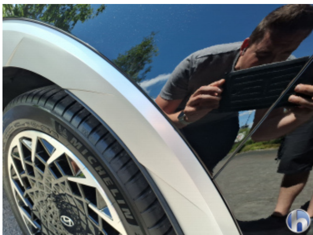
3. Seitenwand - Hinten - Links Kratzer - Smart Repair
