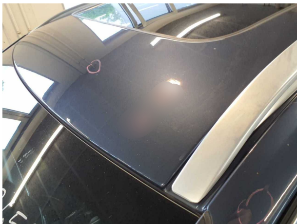
Beschädigung #13: Karosserie: Karosserie - Hagelschaden - sanft instandsetzen
