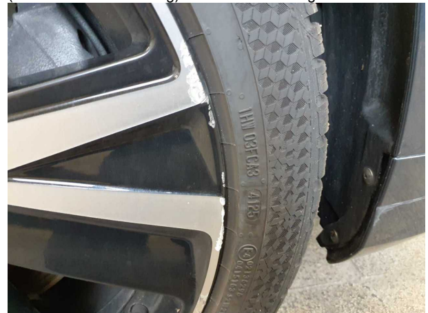
Beschädigung #2: Rad/Reifen: Leichtmetallfelge vorn rechts (Kein Teil der Ausstattung) - Funktion / Zulässigkeit - erneuern
