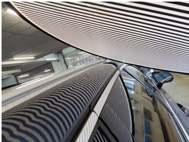
Beschädigung #13: Karosserie: Karosserie - Hagelschaden - sanft instandsetzen
