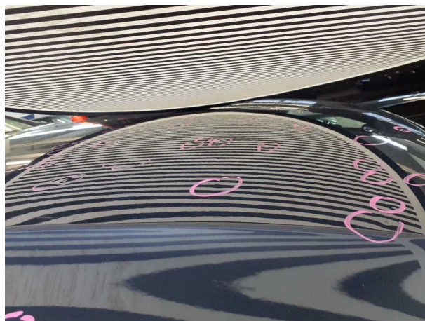
Beschädigung #13: Karosserie: Karosserie - Hagelschaden - sa... instandsetzen
