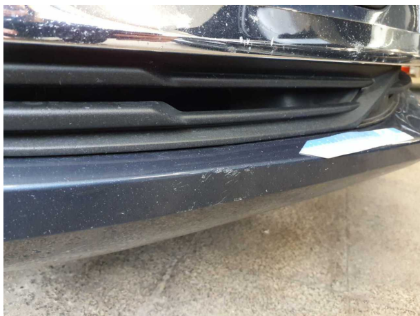
Beschädigung #12: Stossfänger vorn: Spoiler - verkratzt / verschürft - lackieren
