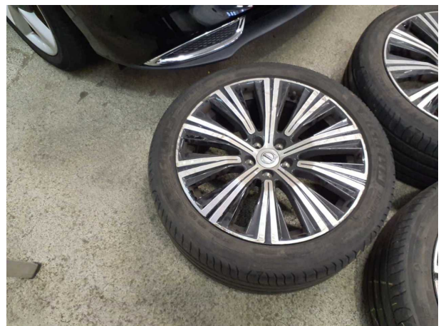
Beschädigung #10: 2.Radsatz: 1 Leichtmetallfelge - verkratzt / verschürft - erneuern
