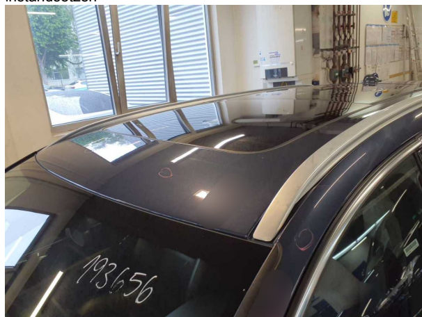
Beschädigung #13: Karosserie: Karosserie - Hagelschaden - sanft instandsetzen
