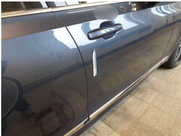
Beschädigung #7: Tür vorn rechts: Tür - Kratzer - Smart Repair
