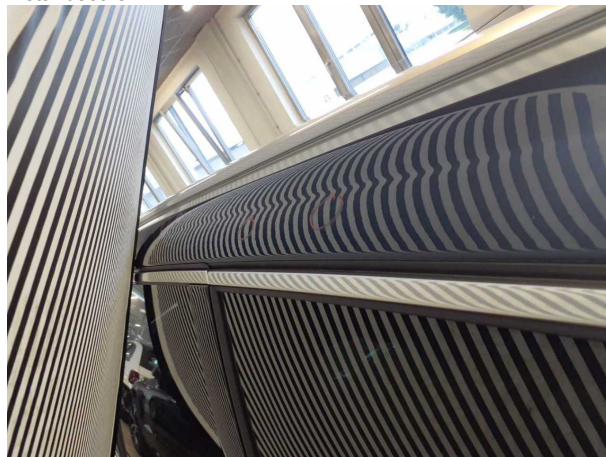
Beschädigung #13: Karosserie: Karosserie - Hagelschaden - sa... instandsetzen
