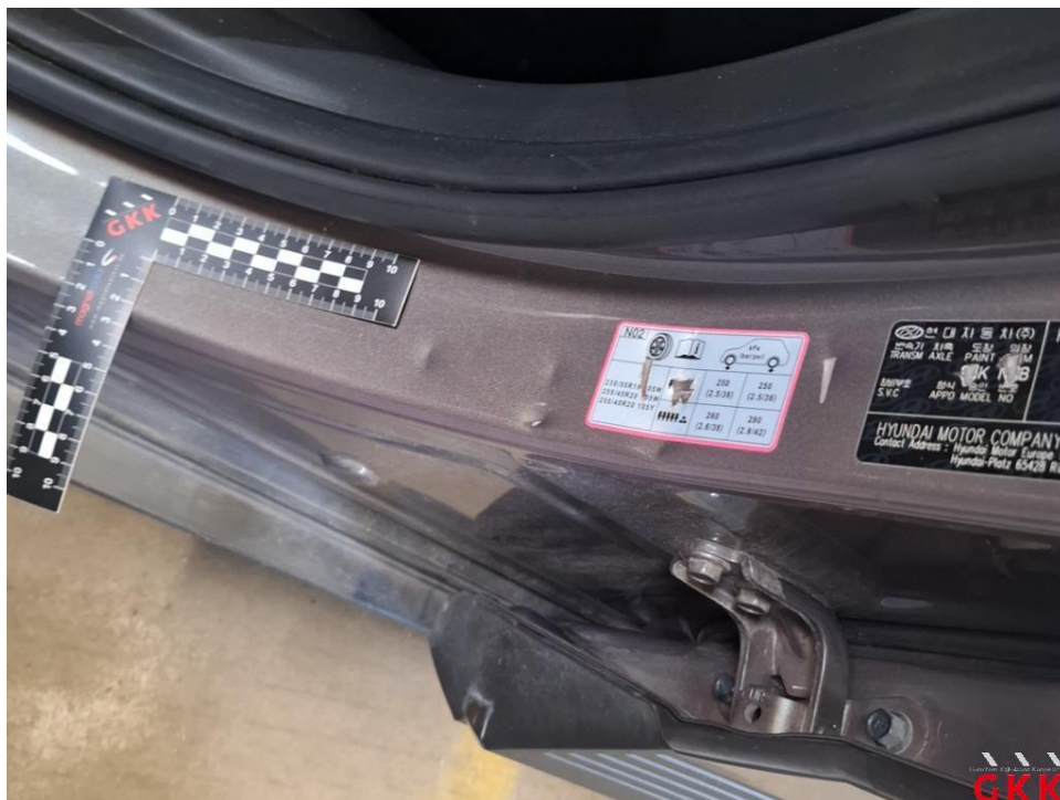
Bild 34 Tür vorne links, Einstieg, beschädigt, instand setzen - lackieren
