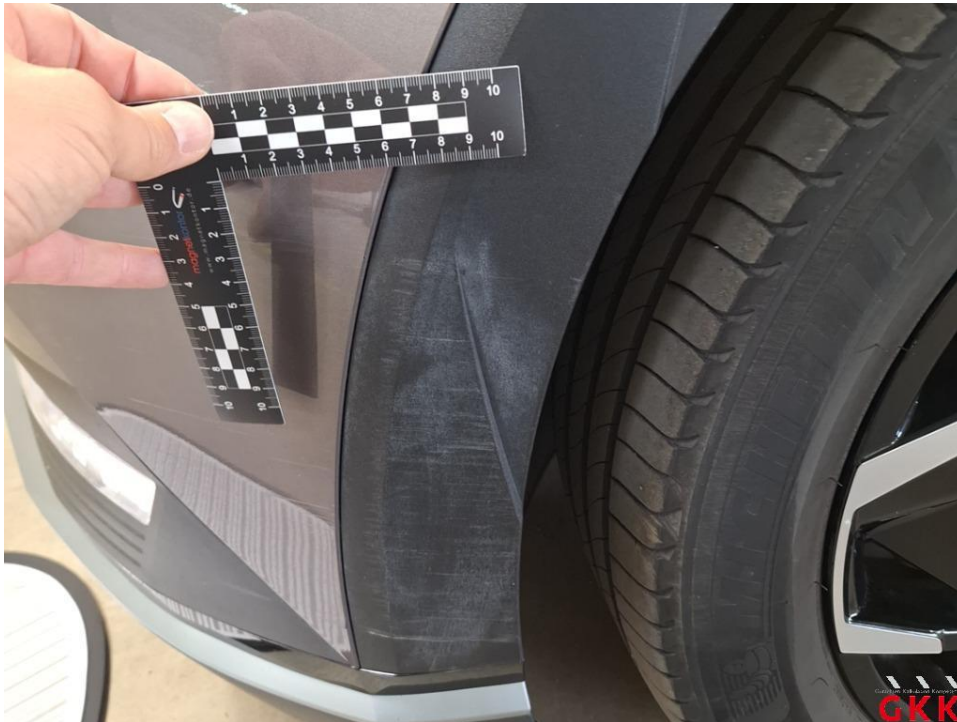
Bild 19 Kotflügel vorne links, Leiste, Radlauf, verkratzt, ersetzen
