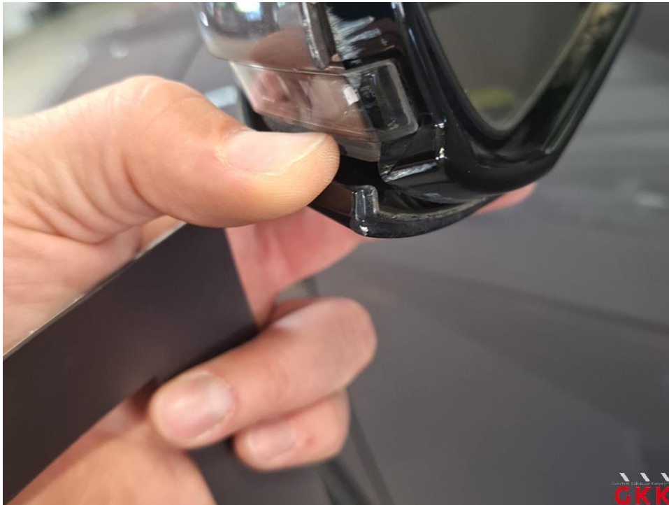
Bild 17 Spiegelgehäuse links, Kappe -lackiert-, gerissen, ersetzen
