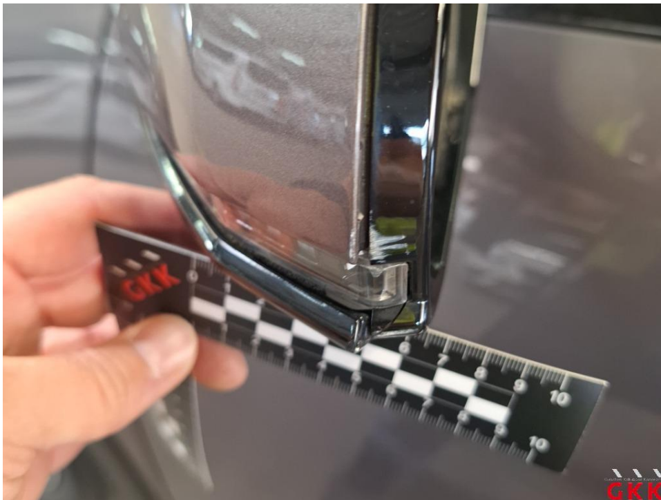
Bild 16 Spiegelgehäuse links, Kappe -lackiert-, gerissen, ersetzen
