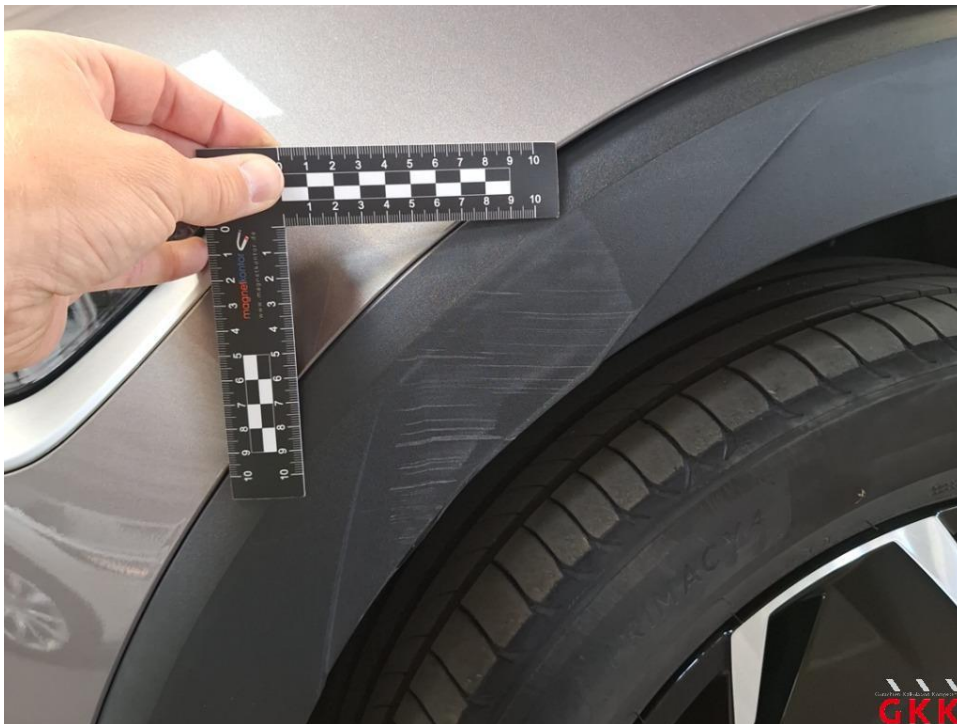
Bild 18 Kotflügel vorne links, Leiste, Radlauf, verkratzt, ersetzen
