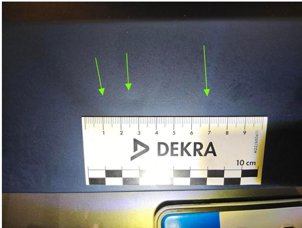
Bild 13 : Heckklappe, eingedellt, instandsetzen und lackieren mit Lackaufbau
