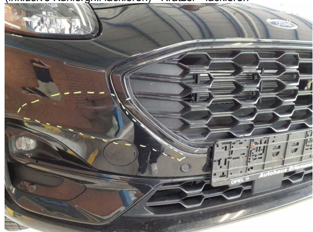
Beschädigung #4: Stossfänger vorn: Stossfänger vorn (inklusive Kühlergrill lackieren) - Kratzer - lackieren
