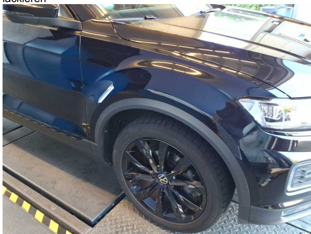
Beschädigung #3: Kotflügel rechts: Kotflügel rechts - Delle / Lackschaden - instandsetzen und lackieren
