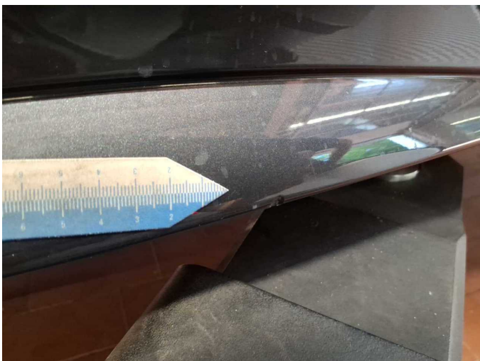
Damage 10: Sill - left side: Trim (Kerbe im Kantenbereich) - Deformed - Replace
