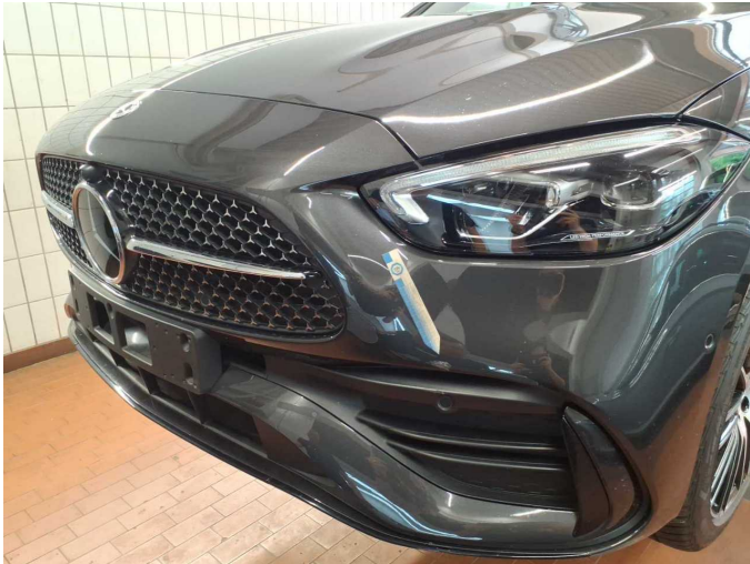
Damage 13: Front bumper: Front bumper (Mit Materialabtrag + Gitter unten links + zierleiste) - Scratched - Paint
