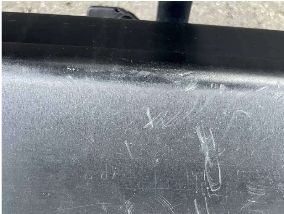
Bild 33 Stoßfängerverkleidung hinten verschürft
