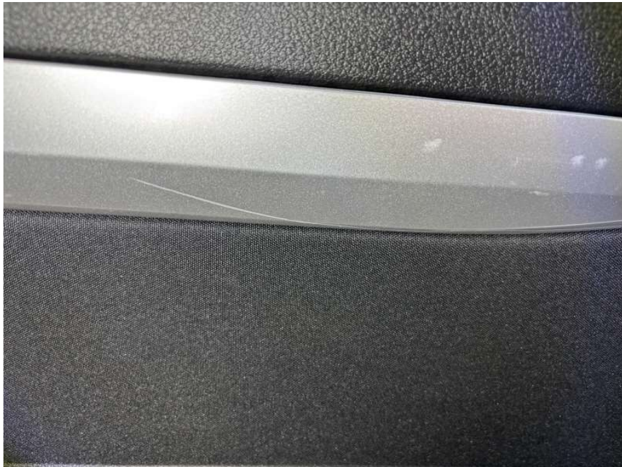
Bild 19 Türverkleidung Schiebetür rechts verschürft/ verkratzt
