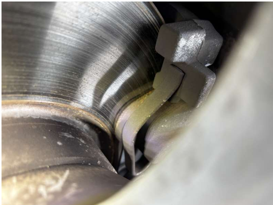
Bild 24 Bremscheiben und Beläge Hinterachse verschlissen
