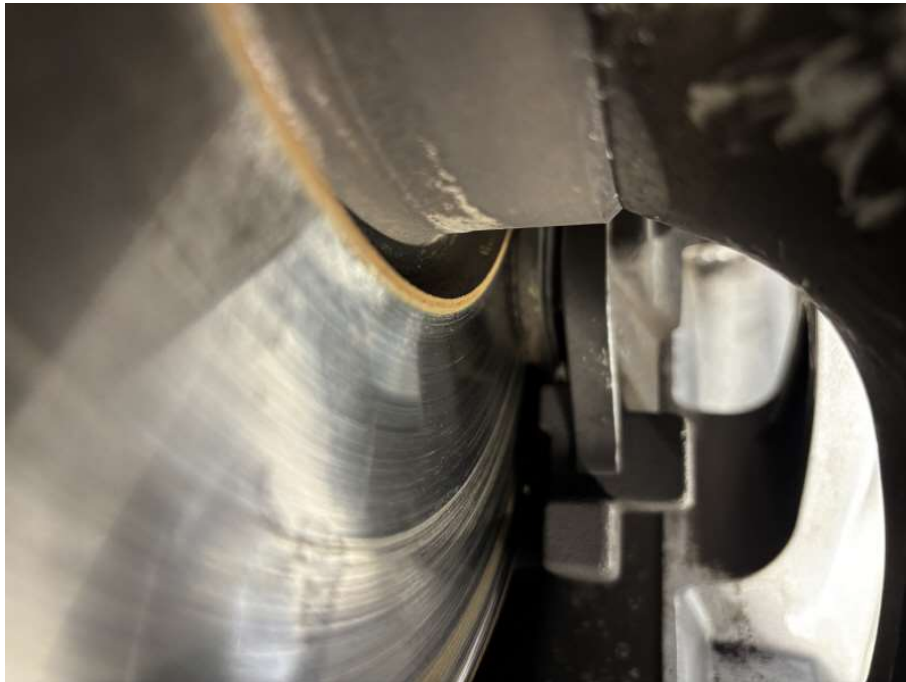
Bild 23 Bremscheiben und Beläge Vorderachse verschlissen
