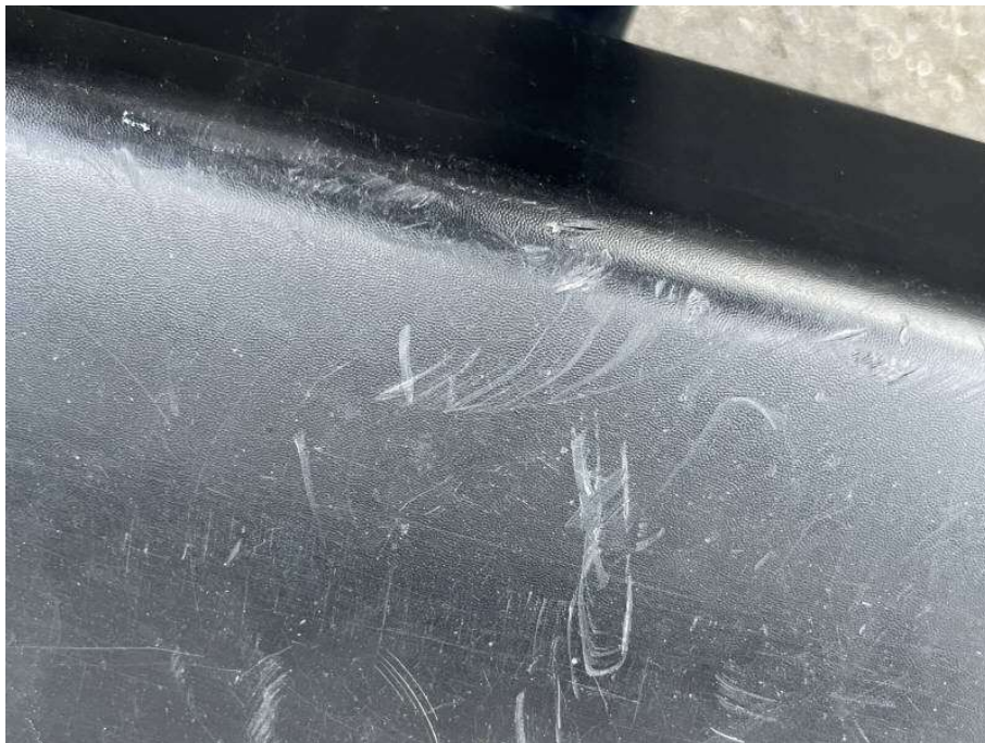
Bild 34 Stoßfängerverkleidung hinten verschürft
