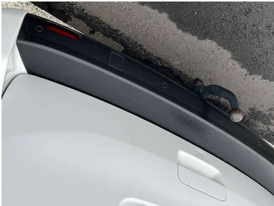
Bild 32 Stoßfängerverkleidung hinten verschürft
