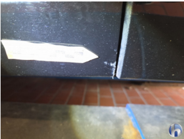
1. Tür Vorne - Links Kratzer - Lackieren
