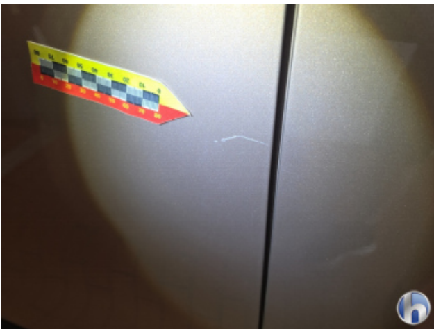
1. Tür Vorne - Links Kratzer - Lackieren
