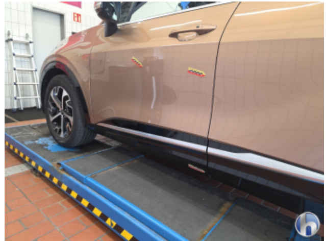
1. Tür Vorne - Links Kratzer - Lackieren
