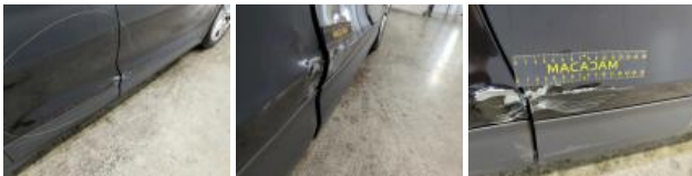
Door trim FR, Scratch(es), Replace
