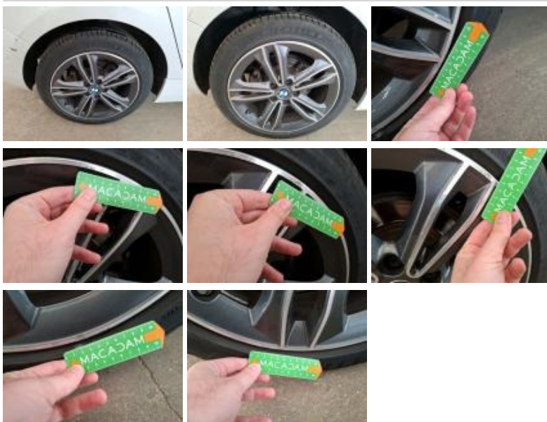
Pneu ARD, Déchirure, E - Remplacer
