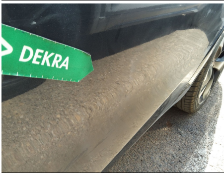
Puerta / Trasero Izquierdo / Mala reparación
