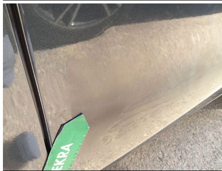
Puerta / Trasero Izquierdo / Mala reparación
