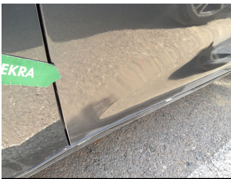
Puerta / Delantero Izquierdo / Mala reparación
