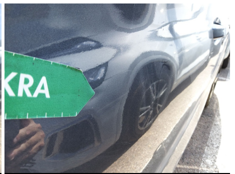
Puerta / Delantero Izquierdo / Mala reparación
